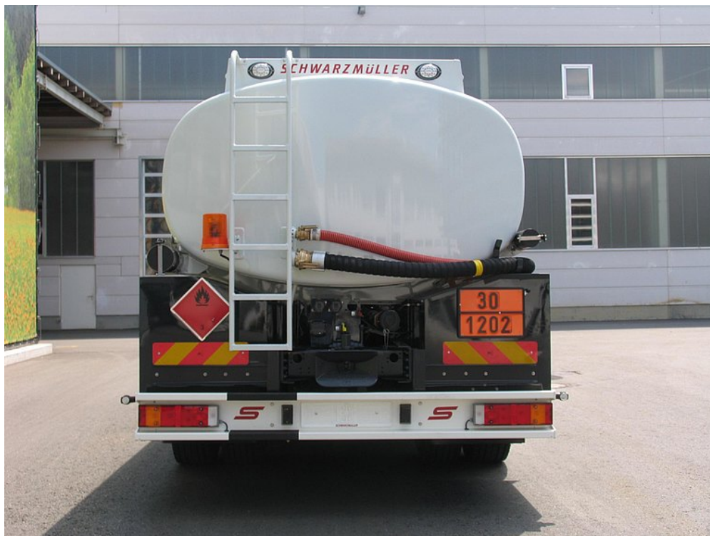
OPCJONALNIE: 2 tylne światła wysoko zamontowane w misce przelewowej
