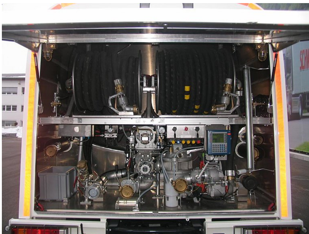
Szafa tylna z podnoszonymi drzwiami na układ pomiarowy i bęben z węzłem
