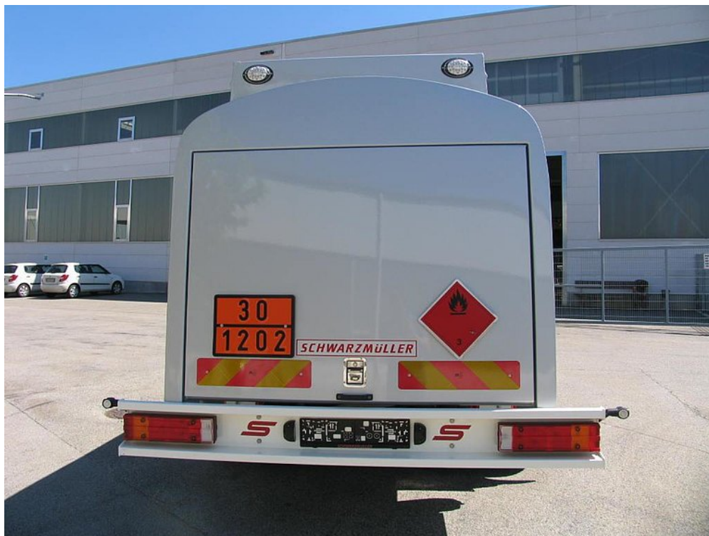
OPCJONALNIE: 2 wpuszczone i zamontowane wysoko tylne światła w tylnej szafie
