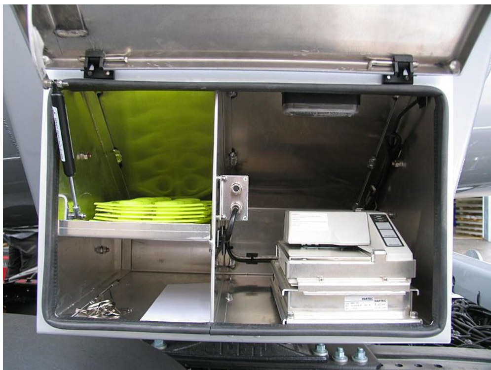
Oddzielna skrzynka na drukarkę zapewnia doskonałą ochronę przed uszkodzeniami mechanicznymi i wpływami atmosferycznymi
