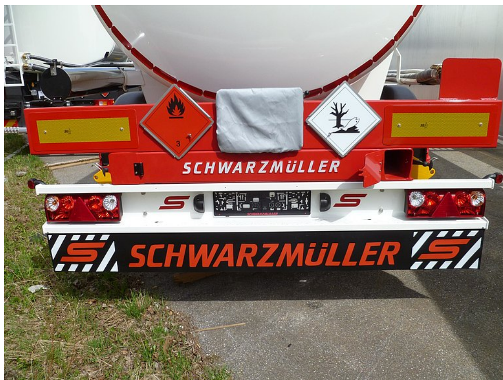
Skrzynie na węże wbudowane w ramę podwozia
