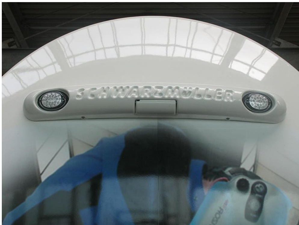
OPCJONALNIE: podniesiony wspornik lampy LED-owej z możliwością zainstalowania zintegrowanej kamery cofania
