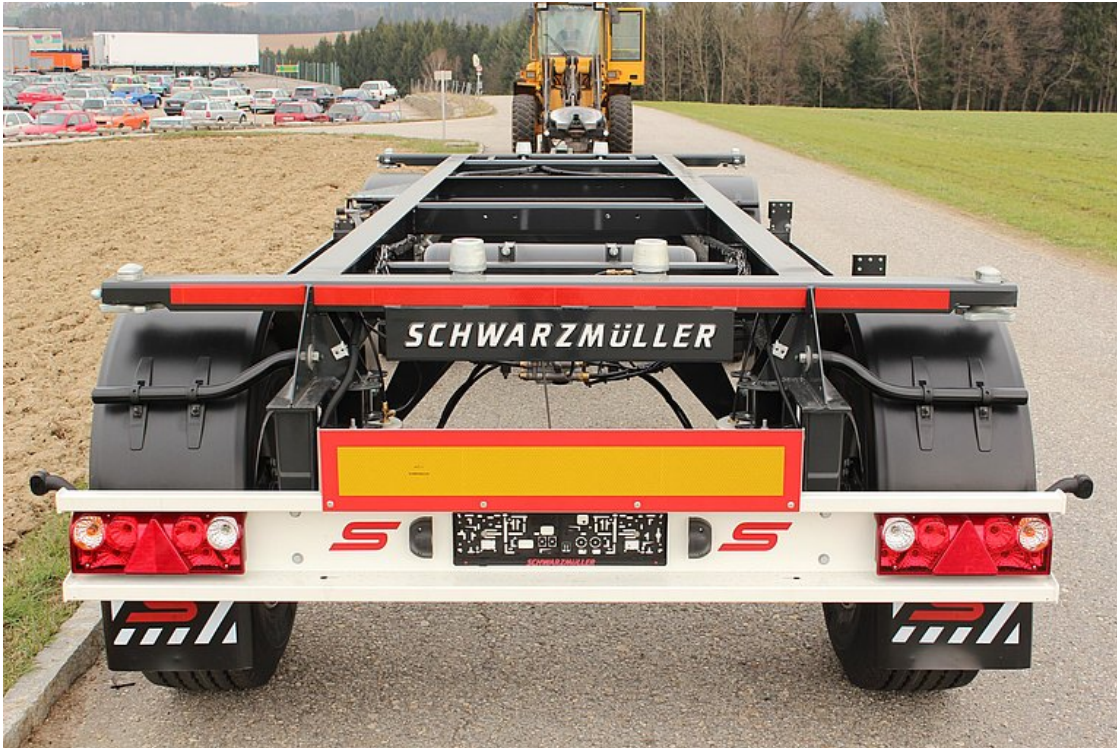
Unterfahrschutz inkl. integriertem Leuchtsystem
