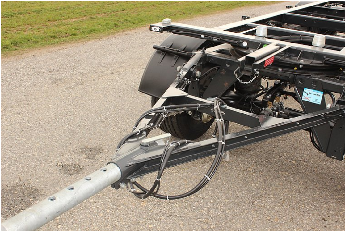
Ausziehbare Zuggabel, max. 600 mm verstellbar, mit Getofix-Deichselstütze
