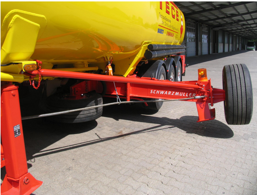
Ausleger mit Knickschutzeinrichtung inklusive Knickschutzseile und Drehlicht in FR rechts
