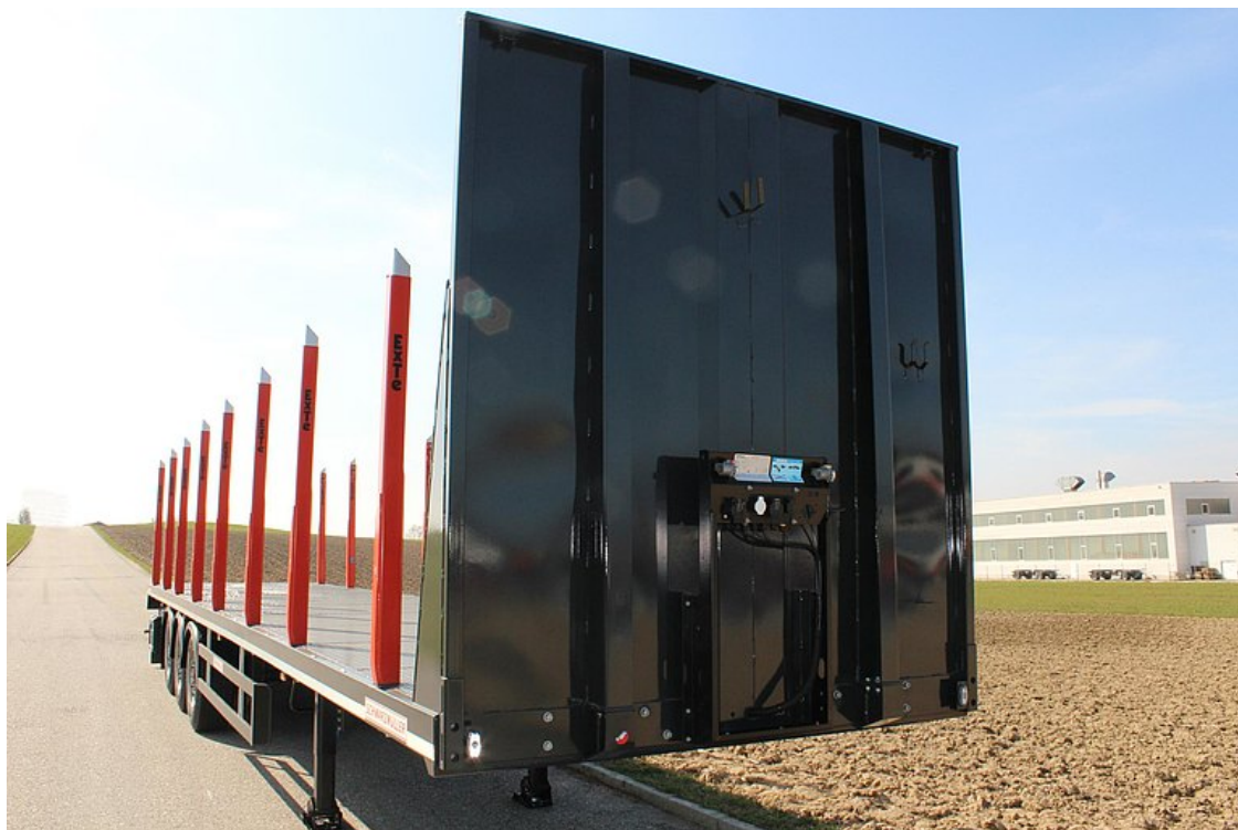
Különösen erős, 2 középtámasszal ellátott mellfal
