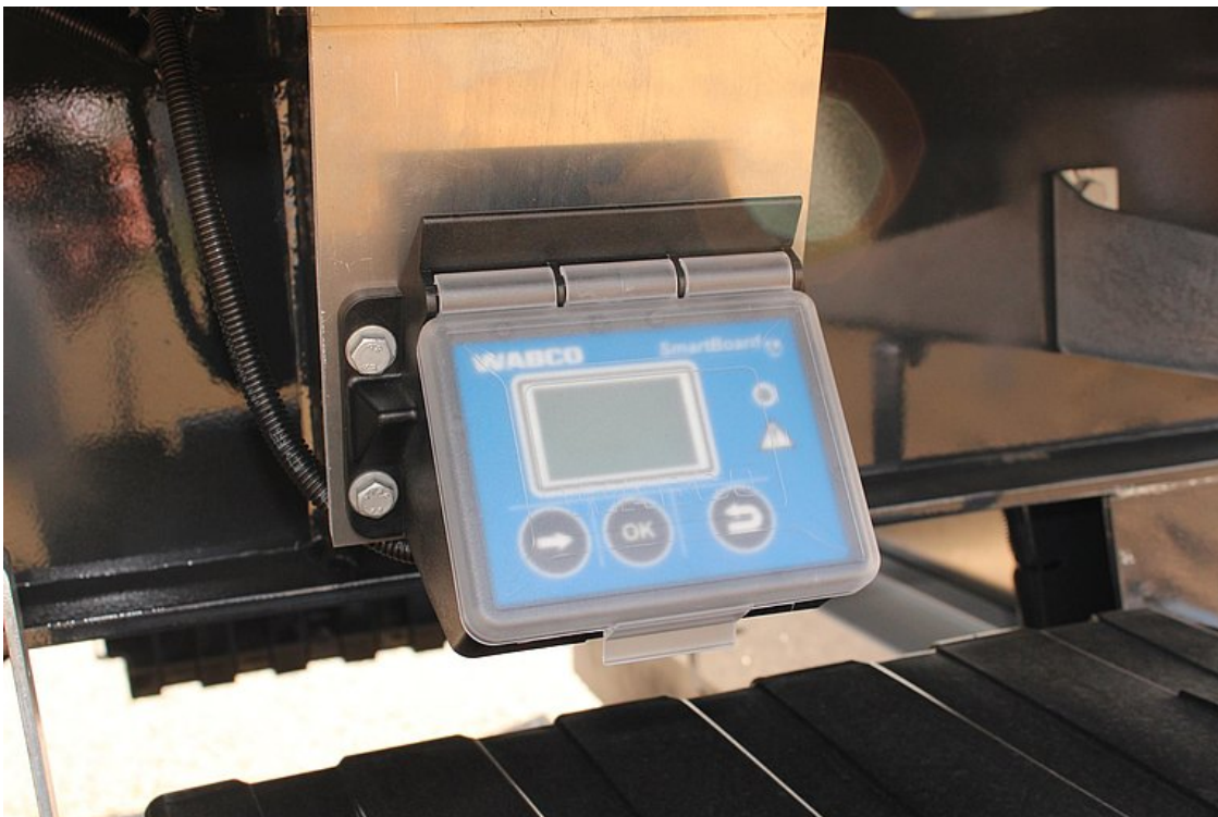
OPCIONÁLIS: SmartBoard a jármű kijelzőjén keresztül történő adatkiolvasáshoz (kilométerállás, tengelyterhelés, fékdiagnosztika stb.)
