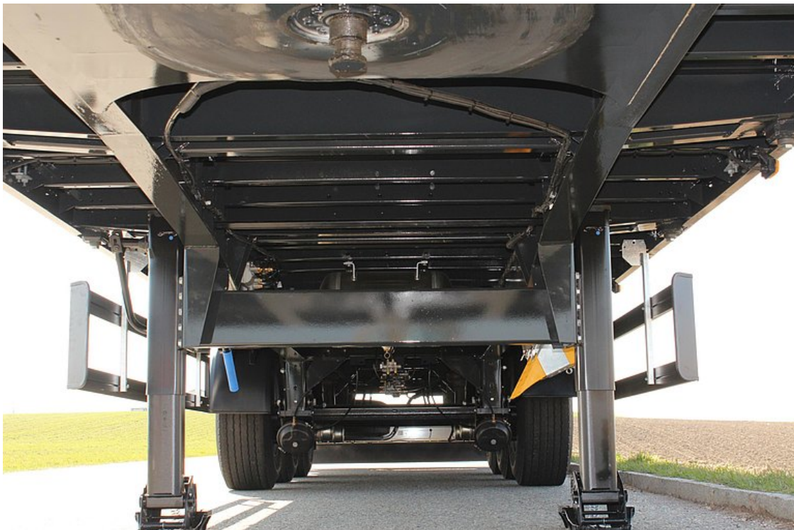
Könnyűszerkezetű alváz, különösen erős NAXTRA acélból és ezáltal akár 500 kg raksúlynövekedés
