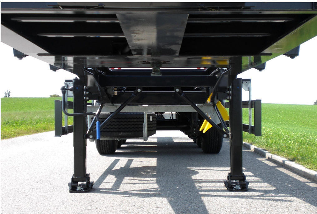
3-tengelyes, rönkszállító félpótkocsi - plató nélkül
