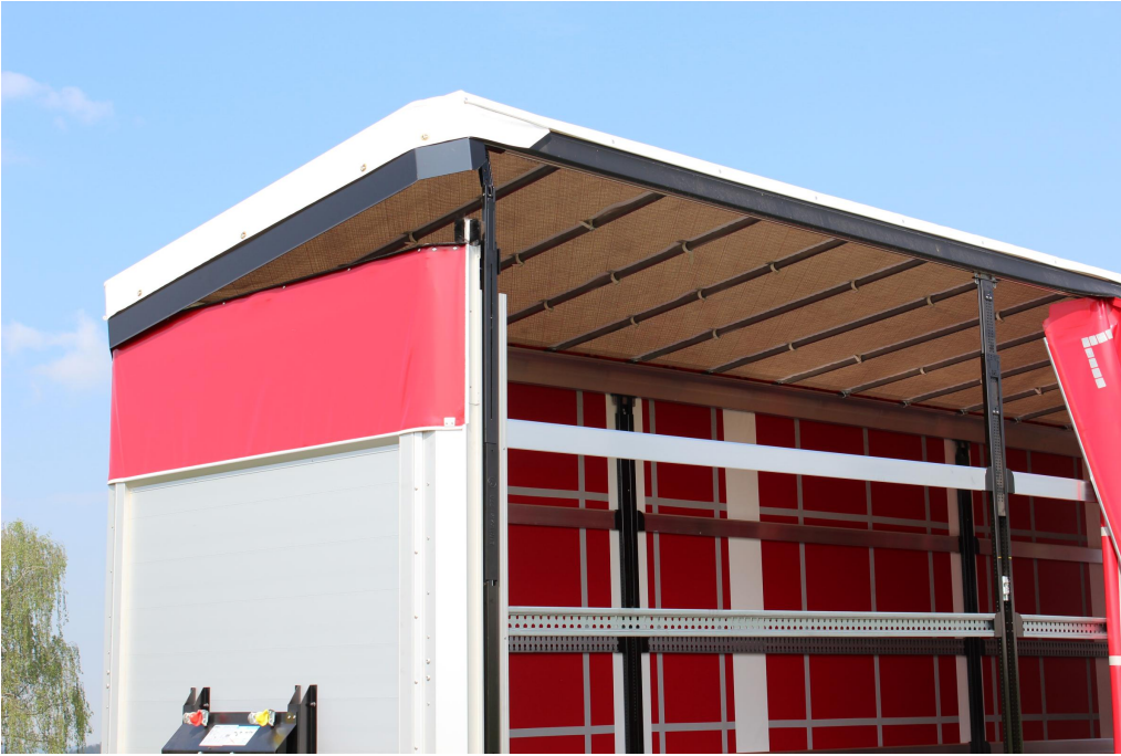
Kézi hidraulikus tetőemelő, mely a gyors be- és kirakodáshoz 400 mm emelést tesz lehetővé
