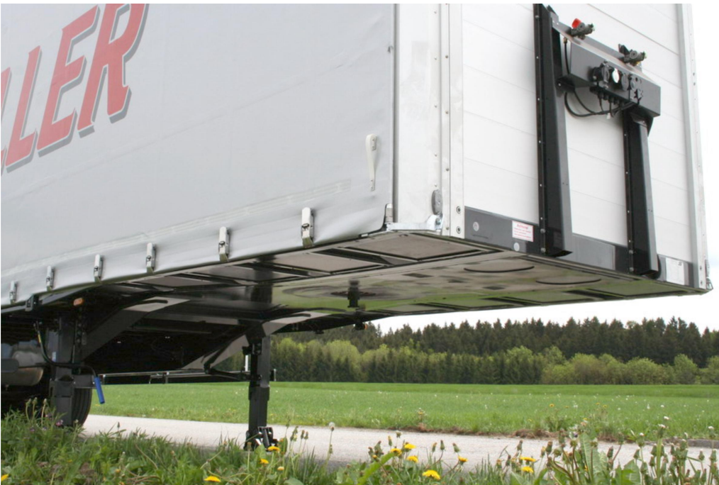
Kézi hidraulikus tetőemelő, mely a gyors be- és kirakodáshoz 400 mm emelést tesz lehetővé
