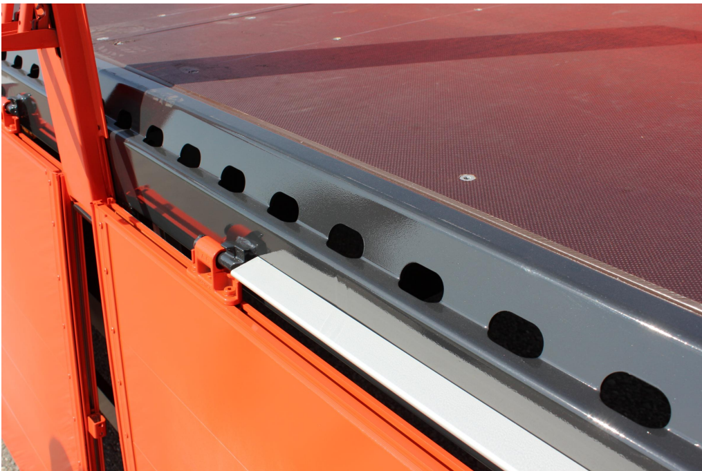
Lekötőgyűrűs keretszegély 15 pár süllyesztett 2,5 t lekötőgyűrűvel a rakományrögzítéshez
