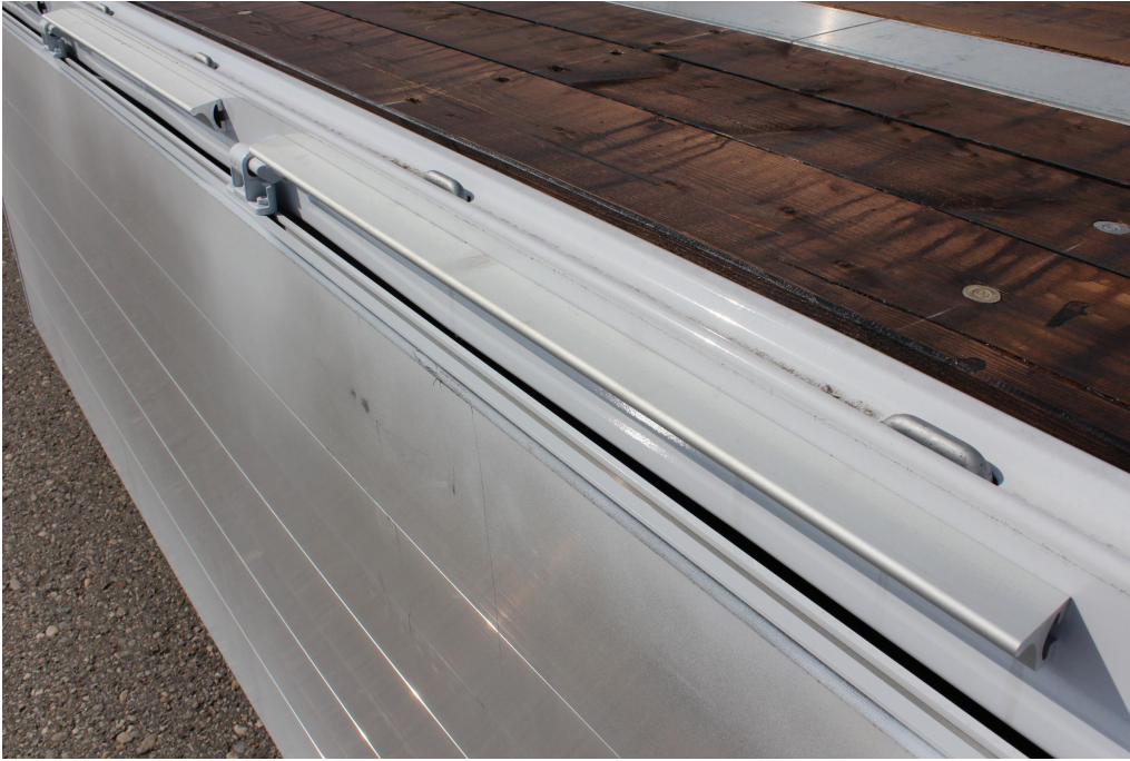
Lekötőgyűrűs keretszegély 15 pár süllyesztett 2,5 t lekötőgyűrűvel a rakományrögzítéshez
