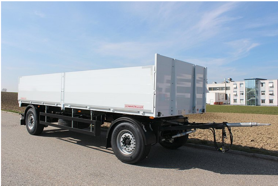
2-tengelyes, síkplatós pótkocsi - építőanyag szállítására
