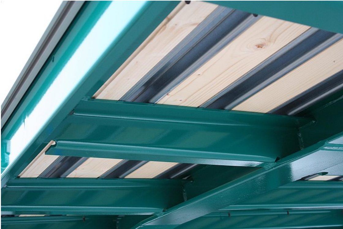
Dupla padló, mely egyrészt acél omegasineekkel erősített fenyőfa padló, valamint egy érdesített koptató lemez (5.460 kg targoncatengely-terhelés)
