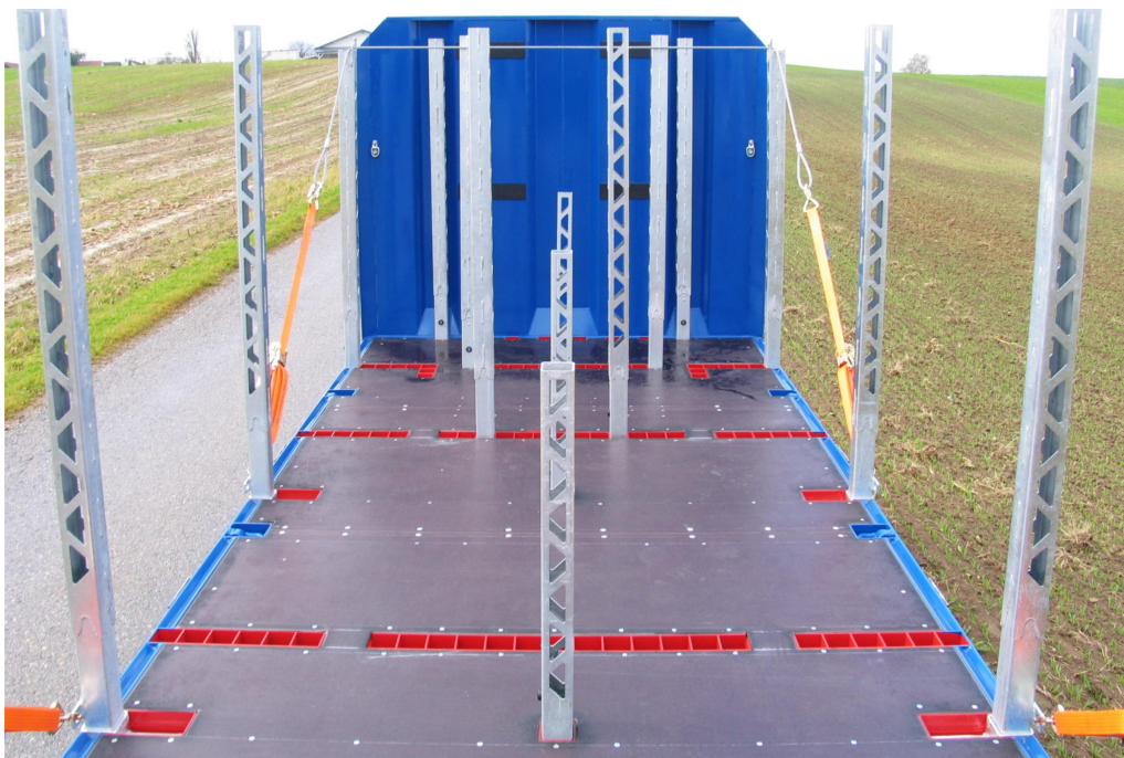
Rakoncazsebek a 6.000 mm hosszú, felhalmozott acélháló rakományrögzítéséhez
