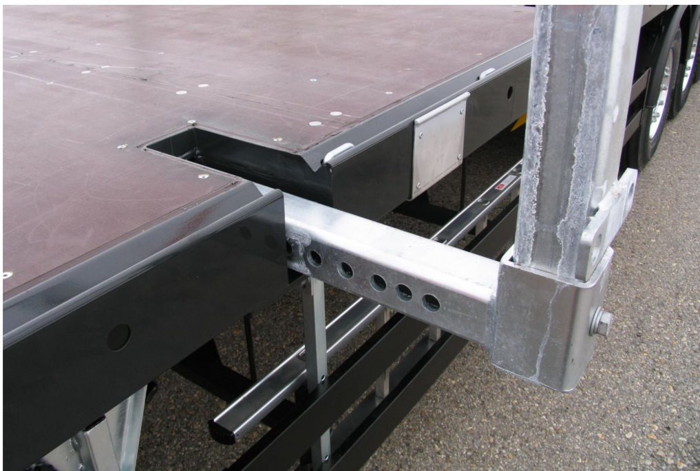
Rakoncazsebek a 6.000 mm hosszú, felhalmozott acélháló rakományrögzítéséhez
