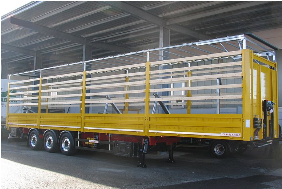
3-tengelyes, könnyűszerkezetű, síkplatós félpótkocsi - tekerccszállító - ferde raktérkialakítás
