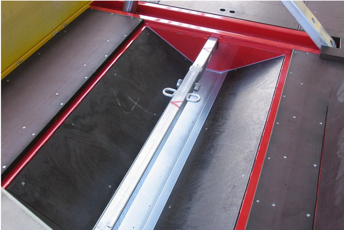
Kábelvályú hasznos hossza 8.000 mm (3 részre osztva), 900 mm és legfeljebb 2.100 mm átmérőjű kábeldobhoz
