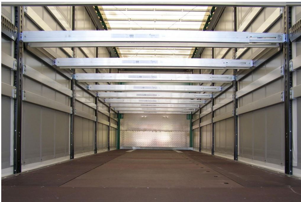
CTD III szerinti dupla rakterű kivitel, 33 Euro-raklap szállítására a 2. raktérben
