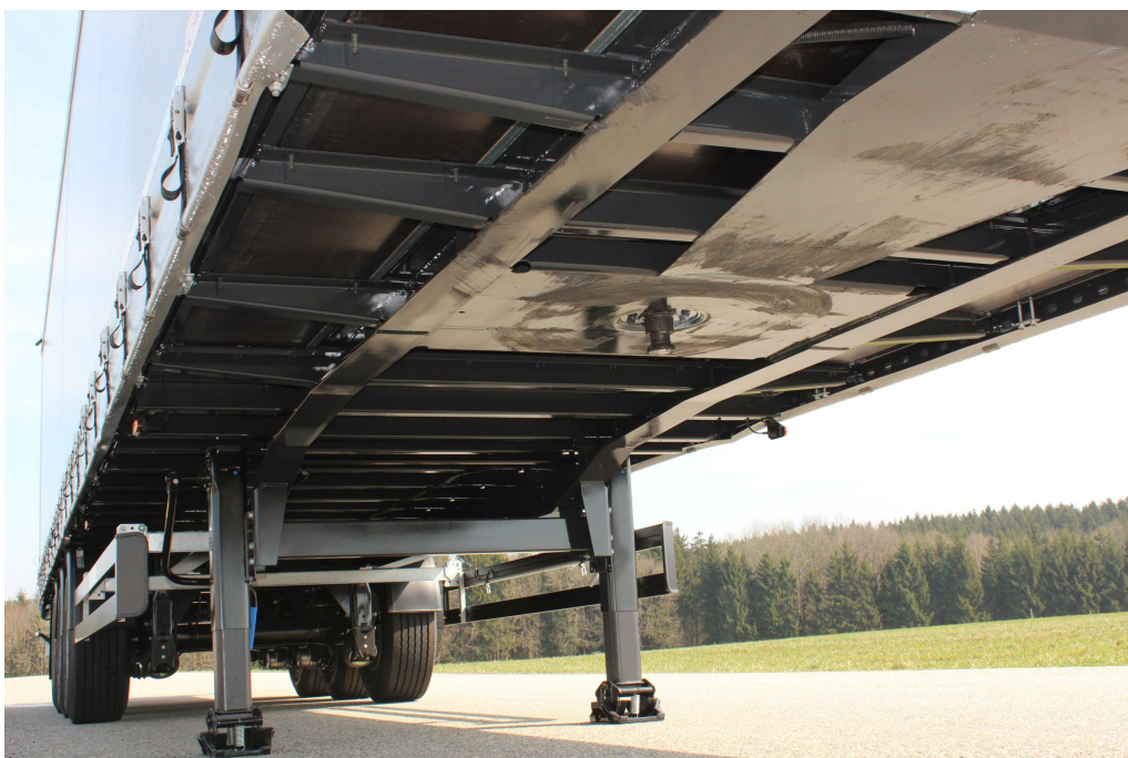
CTD III szerinti dupla rakterű kivitel, 33 Euro-raklap szállítására a 2. raktérben
