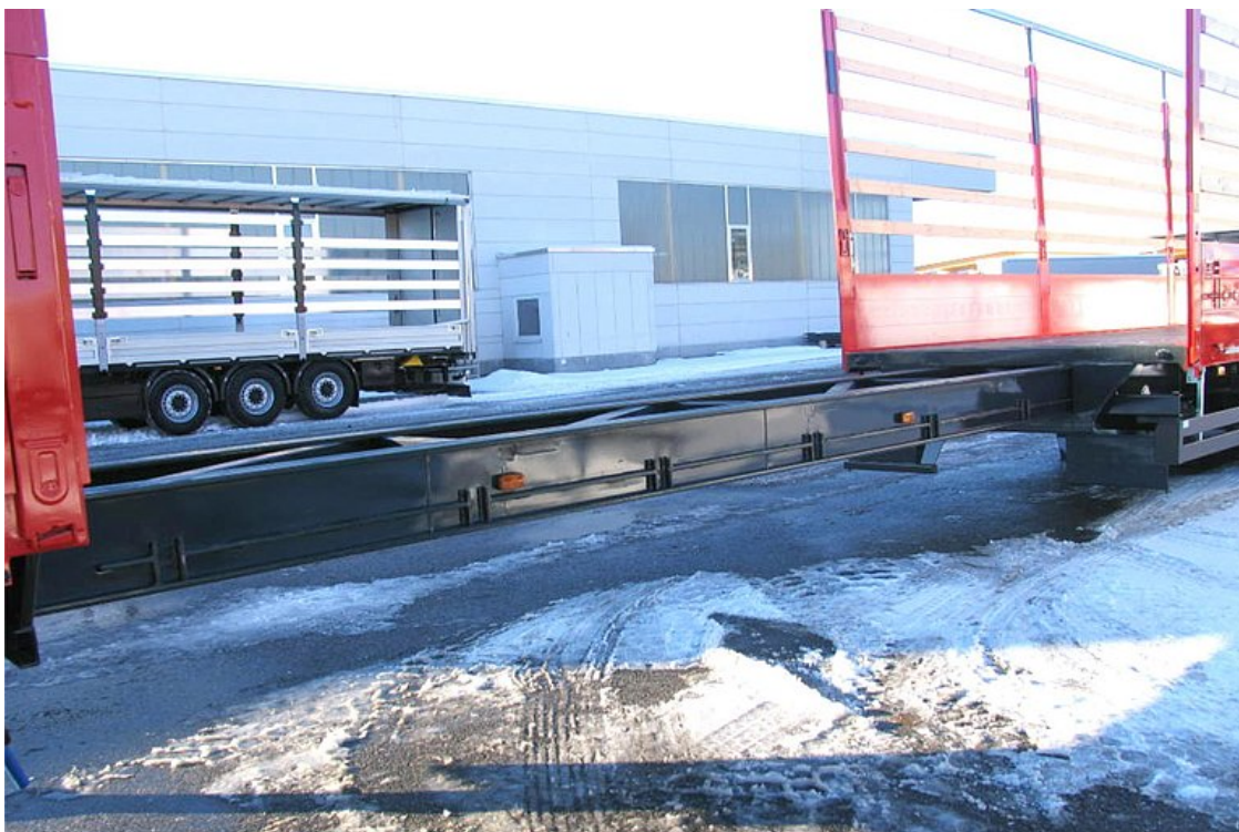
Csavarodástűrő, kihúzható hegesztett acélkonstrukció, 7 pneumatikus reteszelési lehetőség
