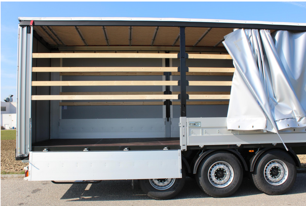
Csavarodásálló hegesztett létra-alváz acélkonstrukció
