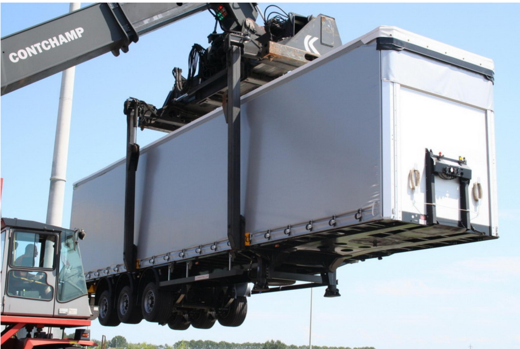
Erősített alvázfelépítés 4 fogadózseb, daruzható vasúti rakodáshoz
