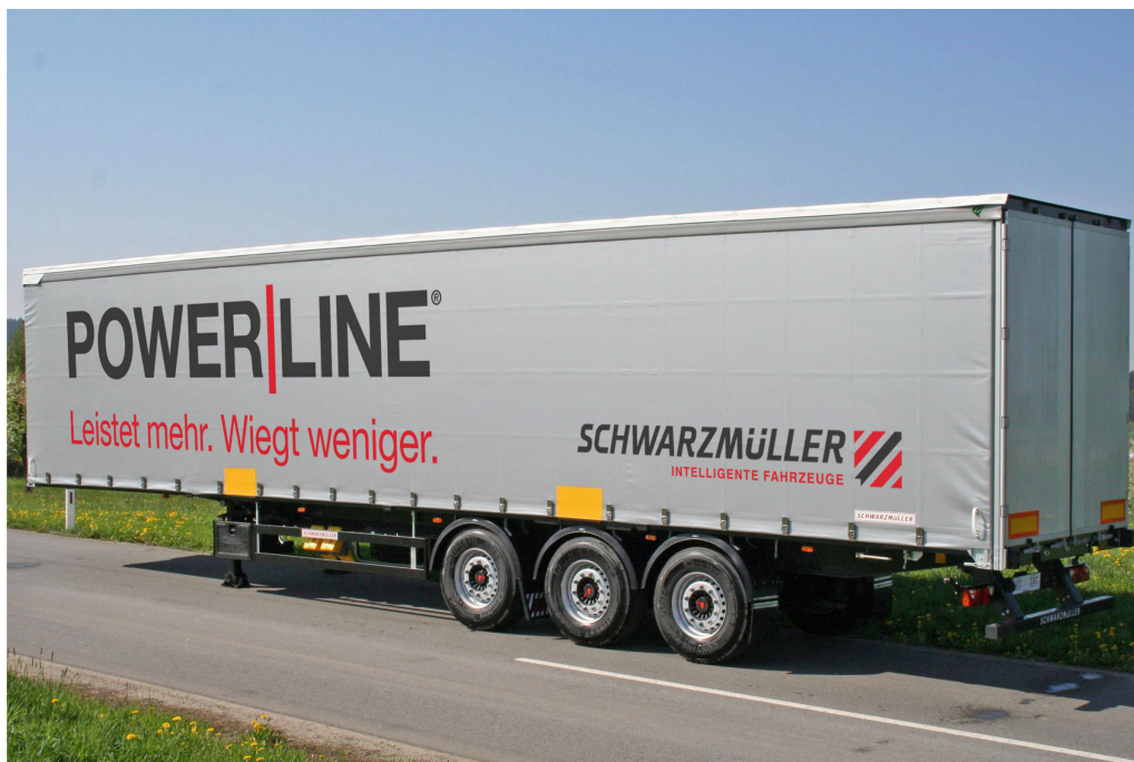
3-tengelyes, függönyponyvás, síkplatós félpótkocsi - tekercsszállító - HucklePack
