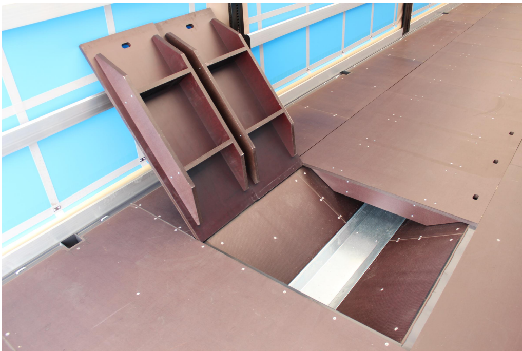
Targoncával járható vályúfedél, 27 mm vastag, rétegelt műgyanta bevonatú padlóval
