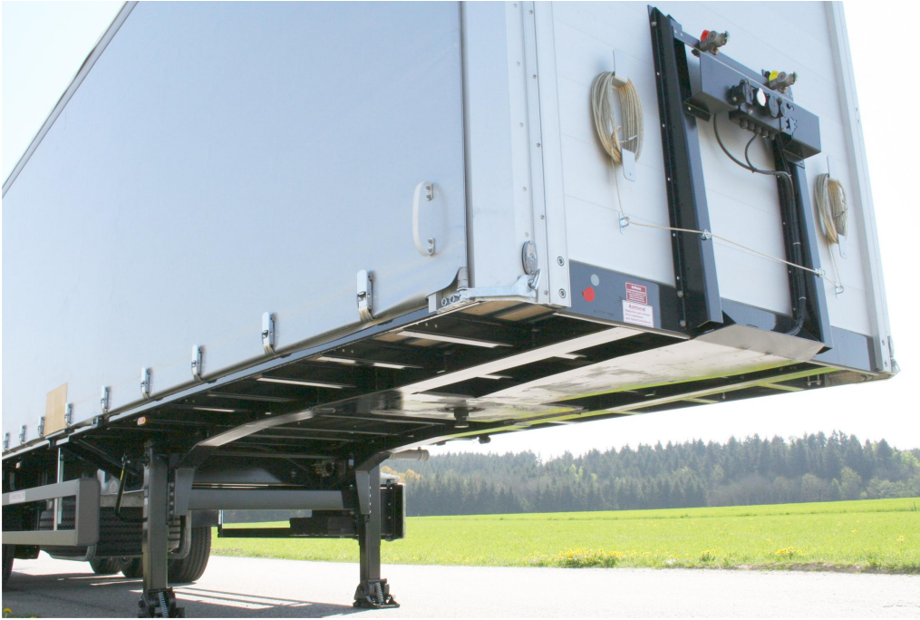
Hegesztett szerkezetű, csavarodástűrő létraváz
