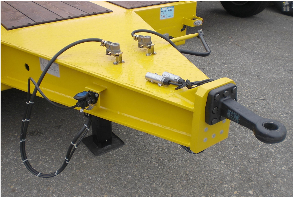
Rakfelület előtt elhelyezkedő vonóberendezés, csavarkötéssel rögzített vonószemmel
