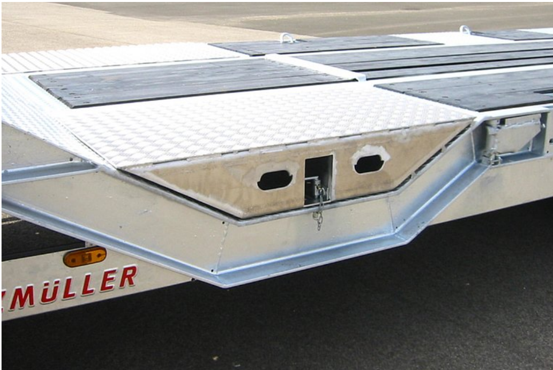
Különböző kialakítású kerékvályúk, a speciális munkagépek szállítására
