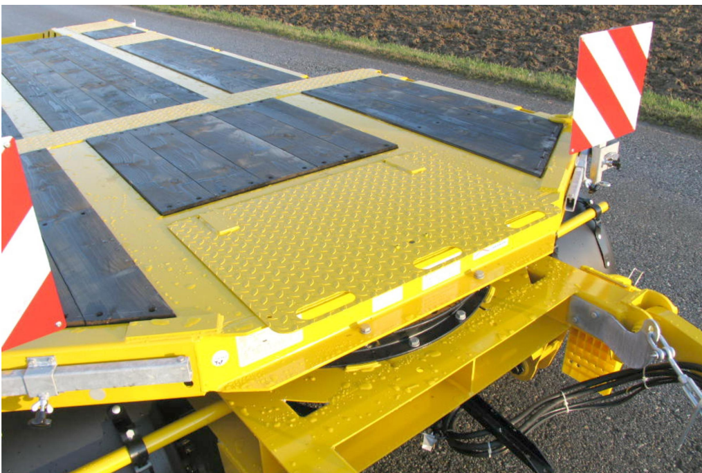
3-tengelyes, hajlított rakfelületű, nehézgépszállító pótkocsi
