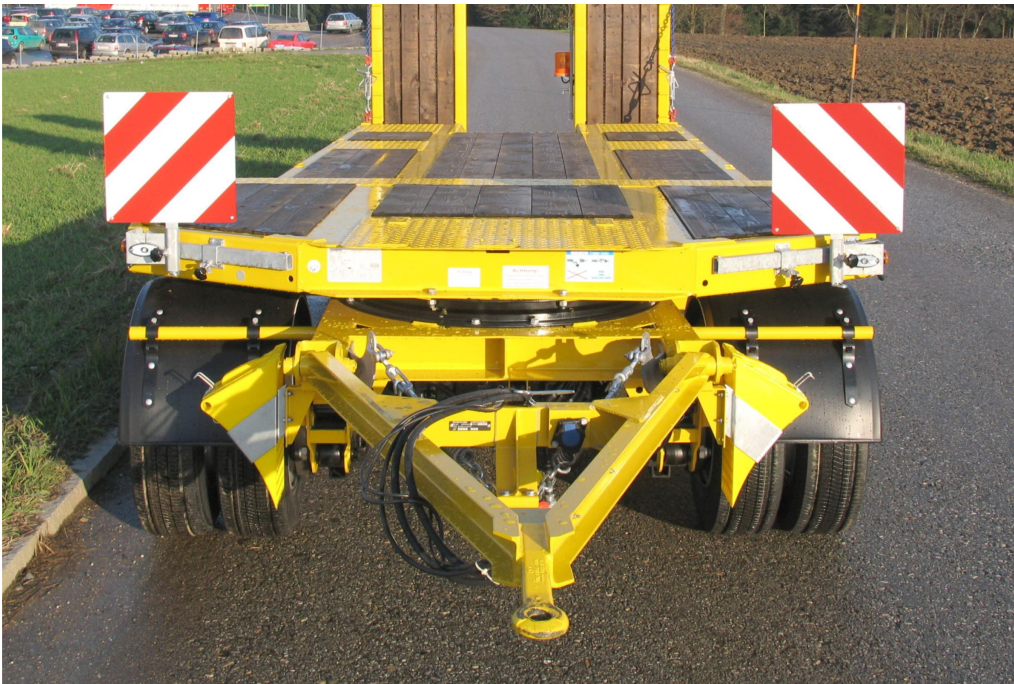
Forgózsámoly és vonóháromszög, kihúzható figyelmeztető táblával
