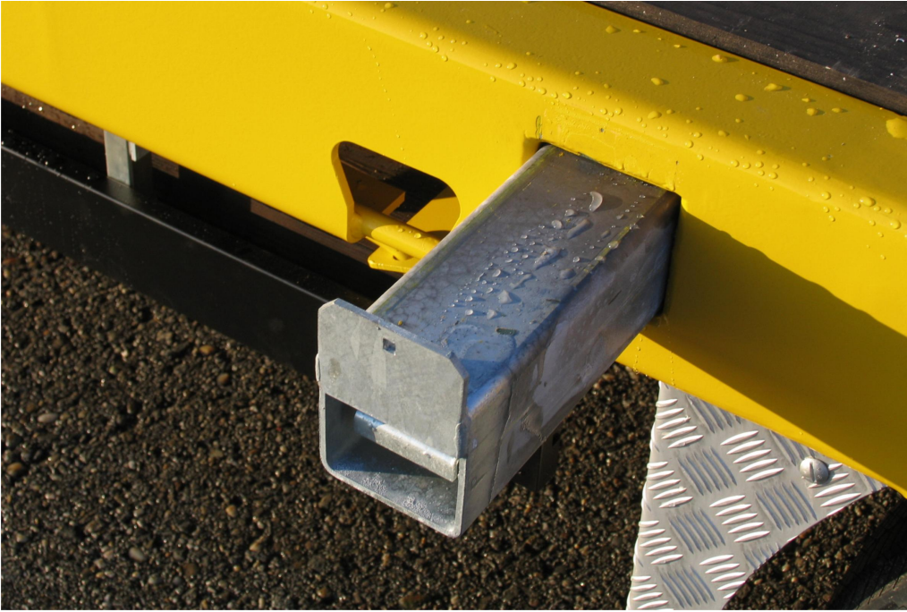
Kihúzható szélesítések pallókkal, túlméretes áruk szállítására
