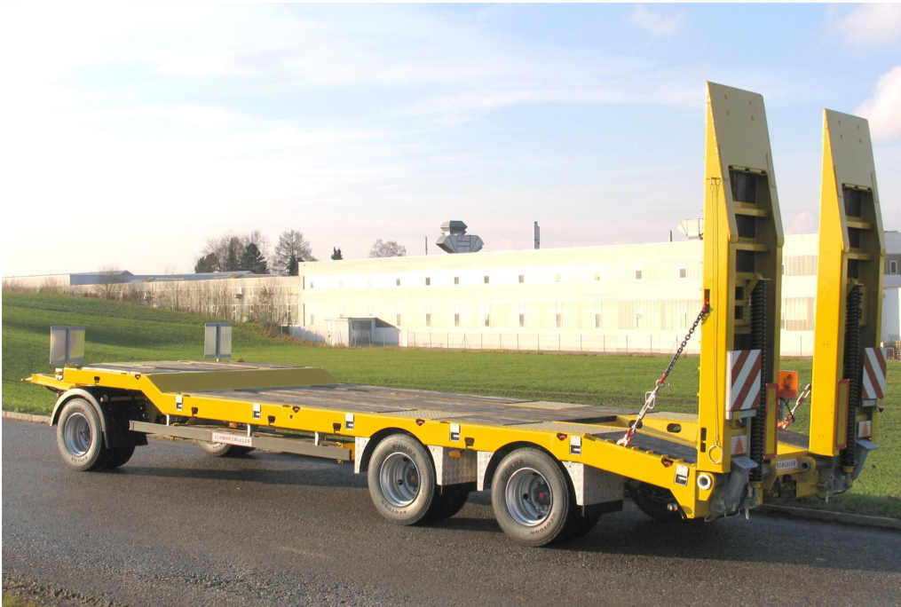
3-tengelyes, hajlított rakfelületű, nehézgépszállító pótkocsi
