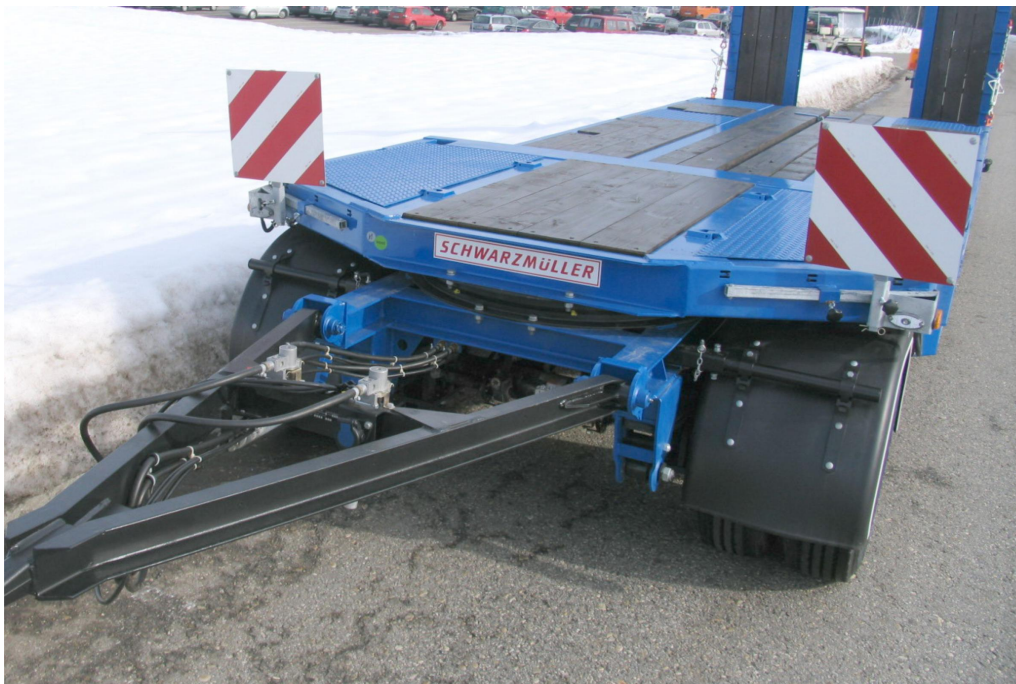
Forgószámoly és vonóháromszög - OPCIONÁLIS: kihúzható figyelmeztető táblával
