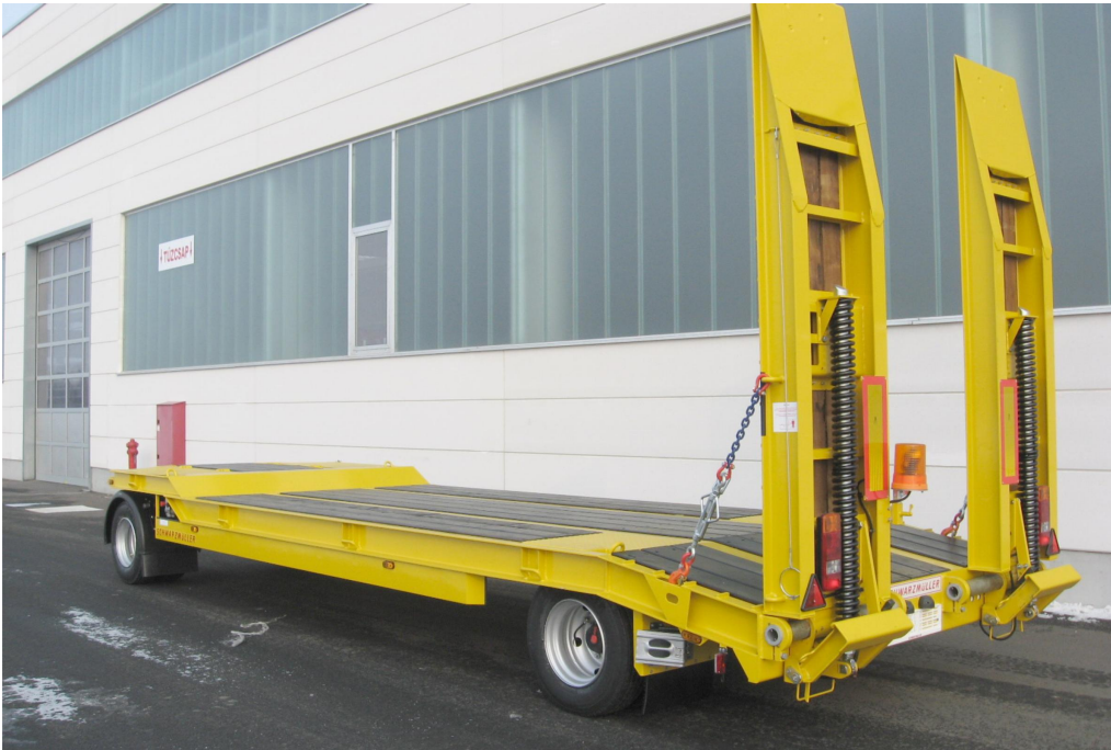
2-tengelyes, hajlított rakfelületű, nehézgépszállító pótkocsi
