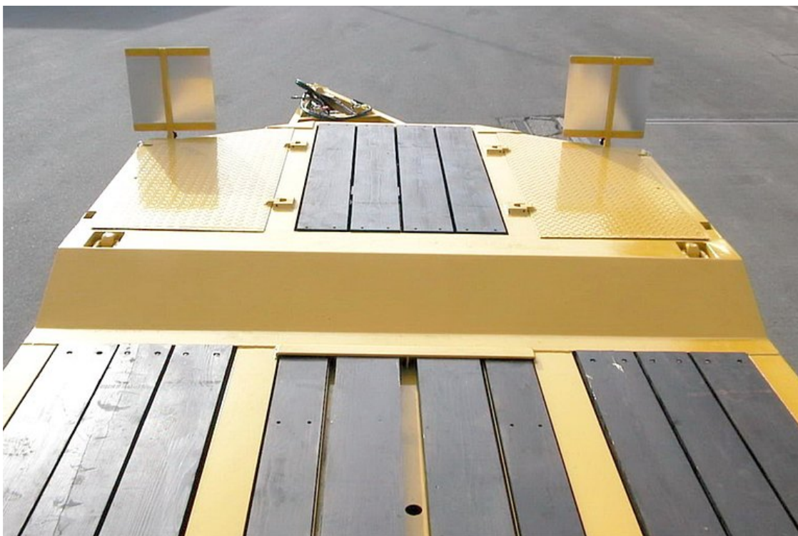
Tárolórecesszel ellátott magasított rakfelület - OPCIONÁLIS: fedél és kihúzható figyelmeztető tábla
