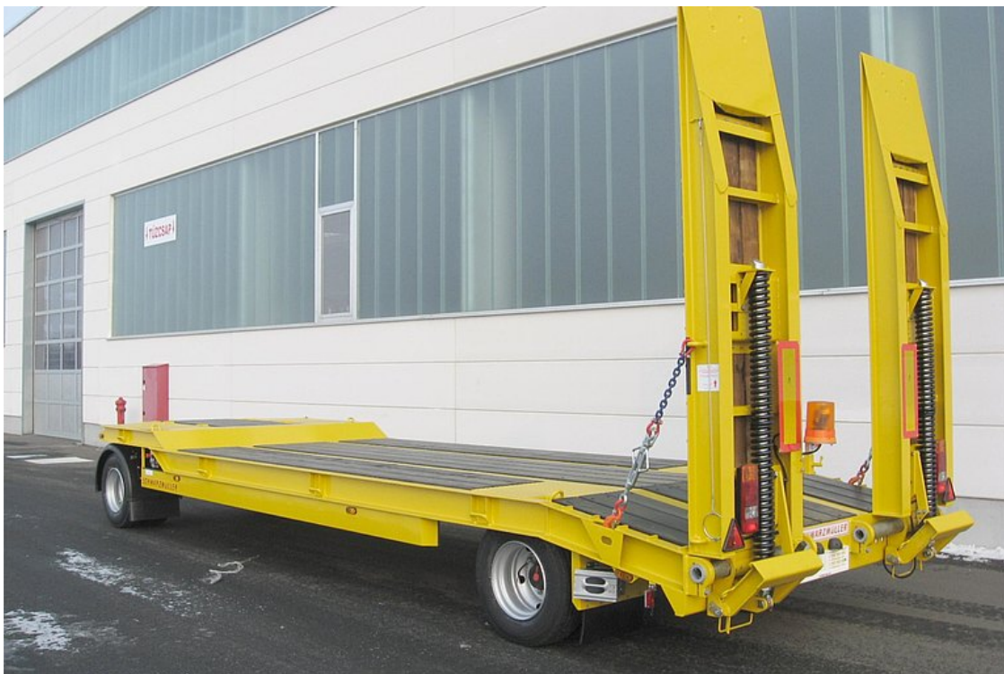
2-tengelyes, hajlított rakfelületű, nehézgépszállító pótkocsi
