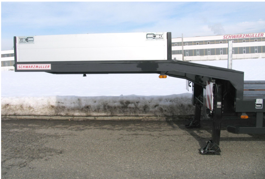
Elöl alvázhajlítással megemelt rakfelület, betűzhető oldalfalakkal
