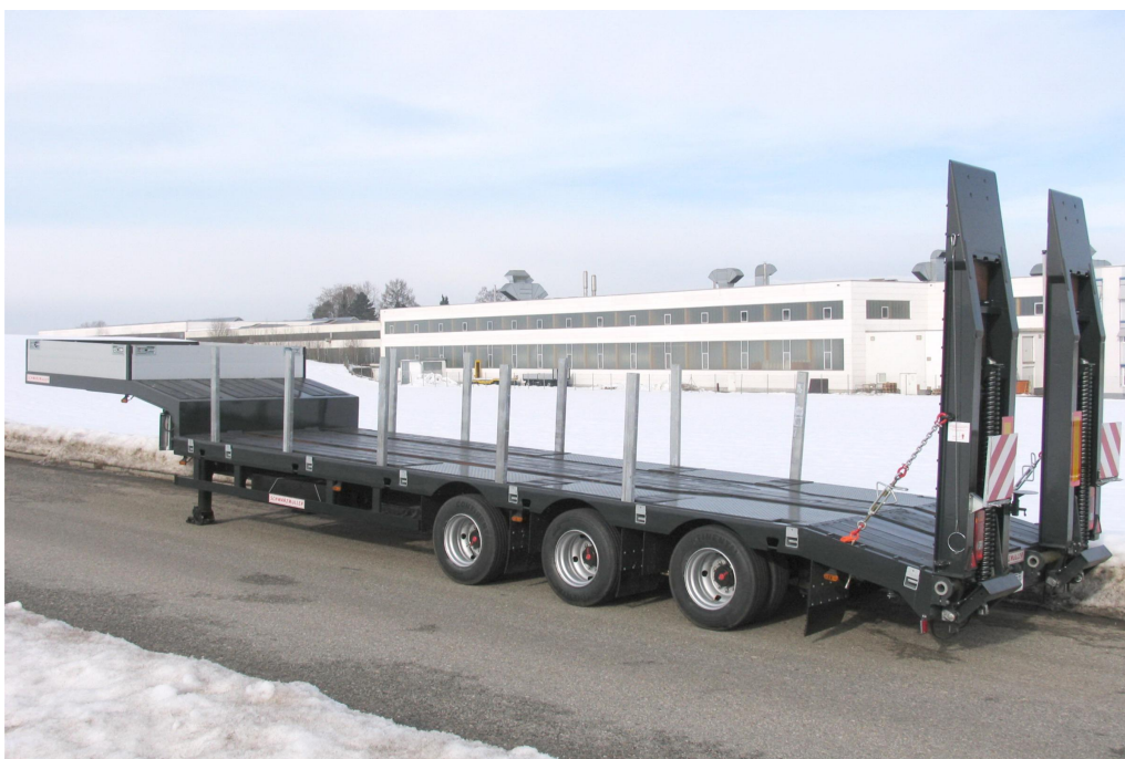
Elöl alvázhajlítással megemelt rakfelület, betűzhető oldalfalakkal
