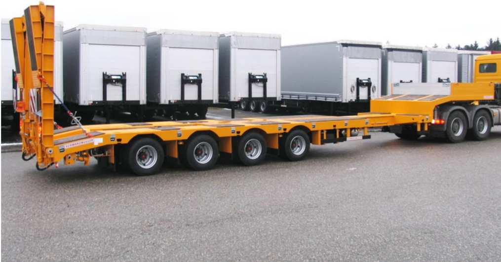
4-tengelyes, nehézgépszállító félpótkocsi - erősített - kihúzható
