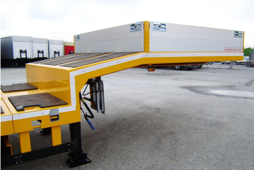
Elöl alvázhajlítással megemelt rakfelület, betűzhető oldalfalakkal
