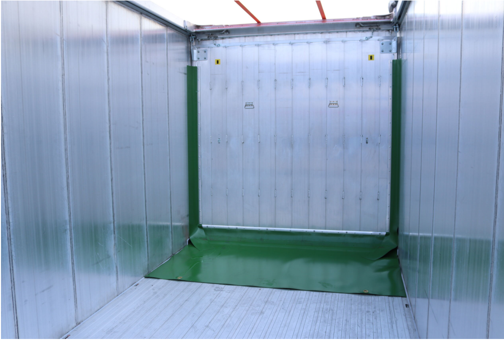
Mozgatható válaszfal a teljes ürítéshez
