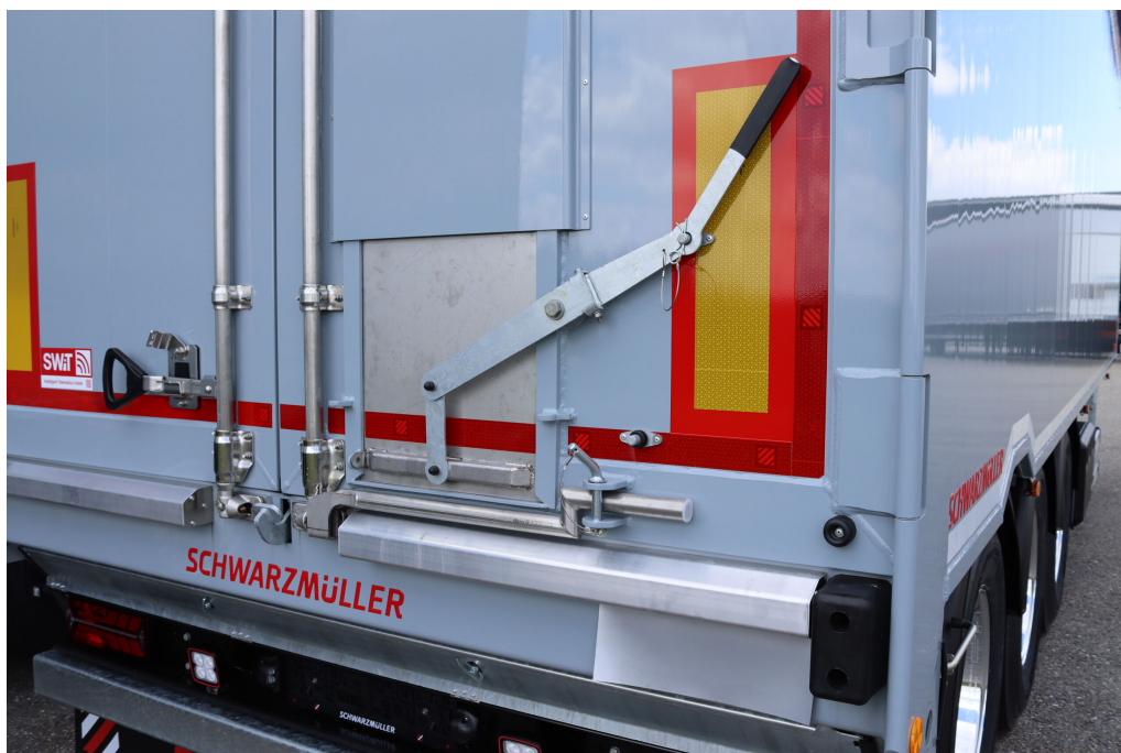
Ponyvavédő lemez a feltekerhető ponyvák védelmére a rakodási folyamat során
