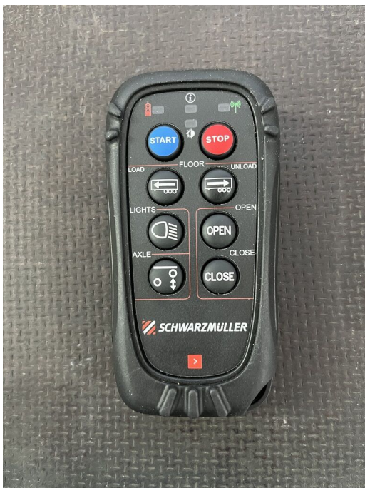
Rádiós távirányító munkalámpák vagy emelőtengely vezérlésével
