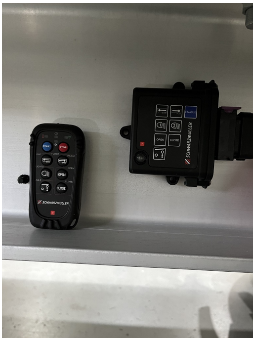
Rádiós távirányító munkalámpák vagy emelőtengely vezérlésével
