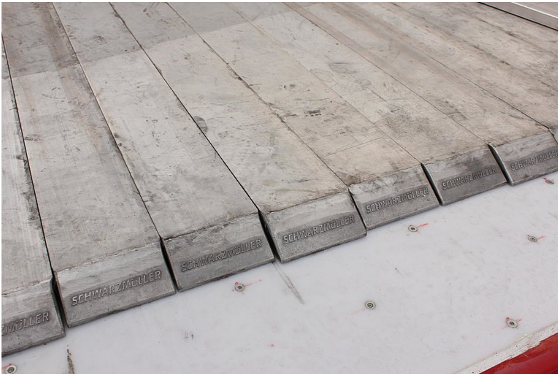
Cargoflor-mozgópadló, hidraulikusan mozgatható 21-profilos rendszer, a ki- és berakodáshoz
