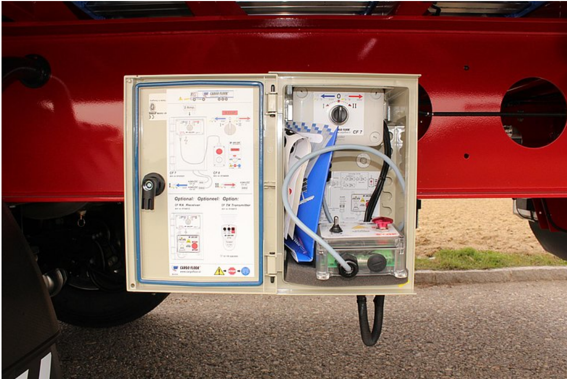
A padló irányítását szolgáló kezelőegység és 10 m hosszú kábel egy vízszigetelt ládában kerül elhelyezésre
