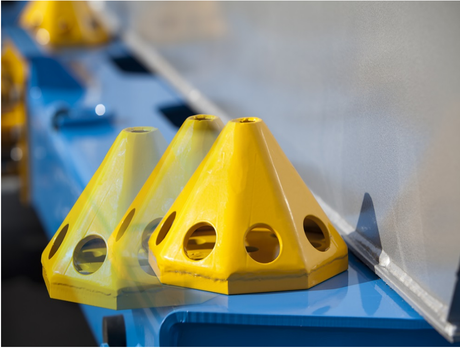
Rakományrögzítés, optimális konténerpozíció 8 db állítható Zentrier-Fix elemmel
