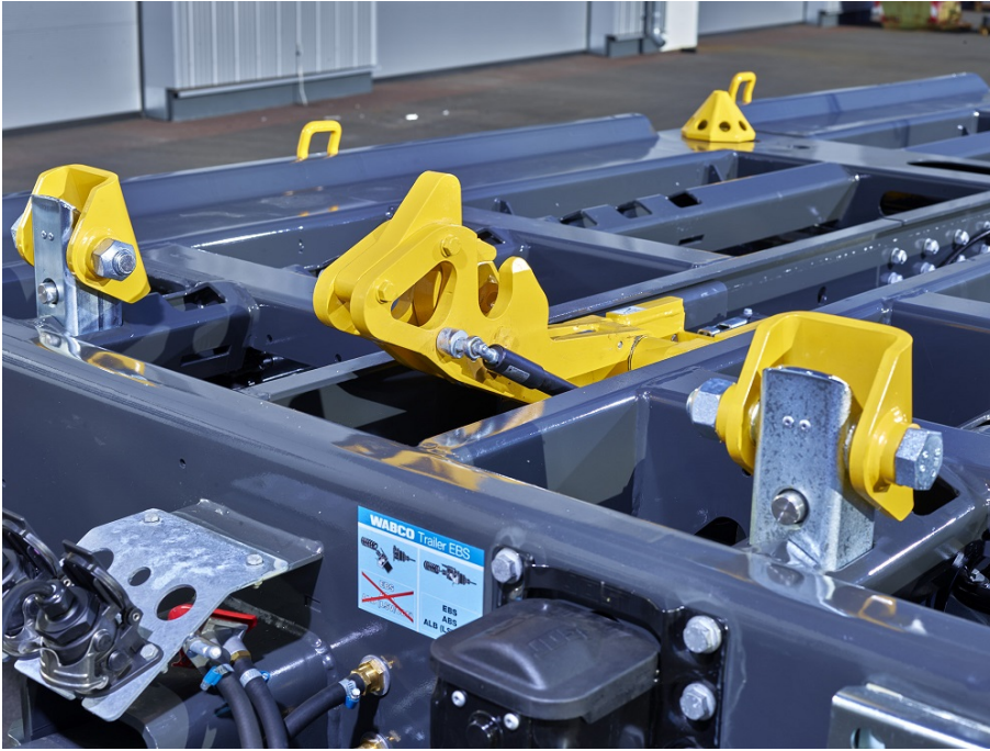
OPCIÓ: lánc nélküli rakományrögzítés - állítható Multi-Fix
