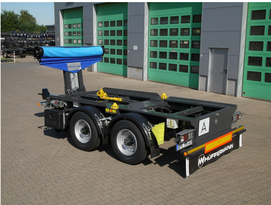
Különböző konténerméretekhez áthelyezhető Zentrier-Fix
