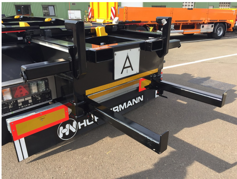
Előlről rakodható kivitel targoncaszállító résszel
