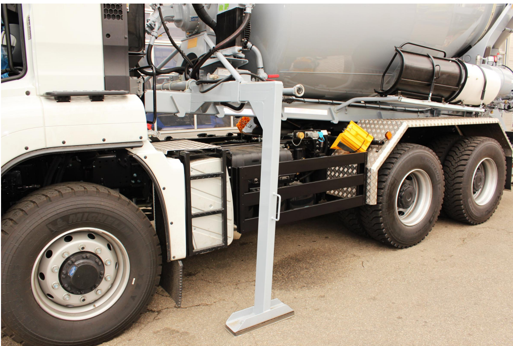
Gyorscsererendszer - 3-oldalra billenő felépítmény / betonkeverő
