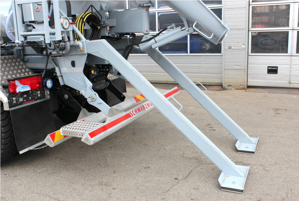
Ferdén hátra futó letalpalók a felépítmény biztonságos leállításához
