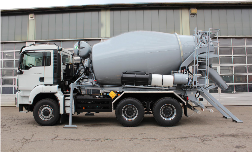
Gyorscsererendszer - 3-oldalra billenő felépítmény / betonkeverő
