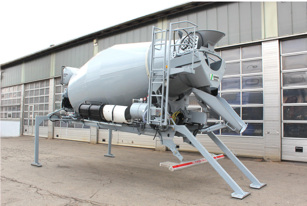
Ferdén hátra futó letalpalók a felépítmény biztonságos leállításához
