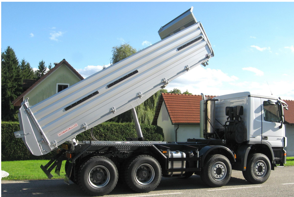
3-oldalra billenő felépítmény, 4-tengelyes járóképes alvázra - építőipari kivitel
