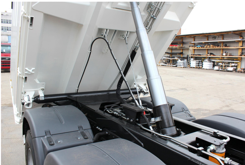
3-oldalra billenő felépítmény, 4-tengelyes járóképes alvázra - építőipari kivitel
