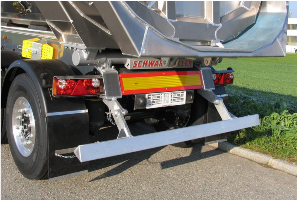
Felhajtható, alumínium trapézprofil hátsó aláfutásgátló
