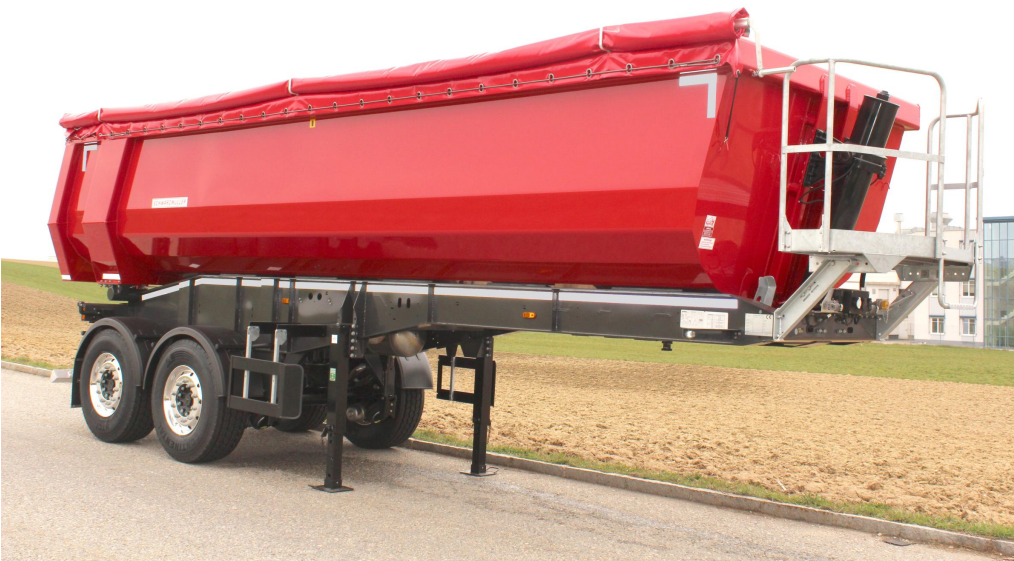
2-tengelyes, hátrabilenő félpótkocsi, szegmentívú alumínium puttonnyal
