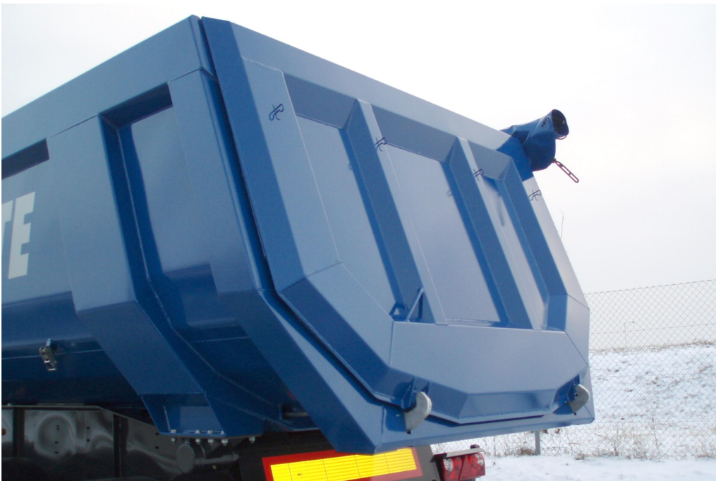
Ferde kivitelű mellfal, magas minőségű krómozott munkahengerrel
