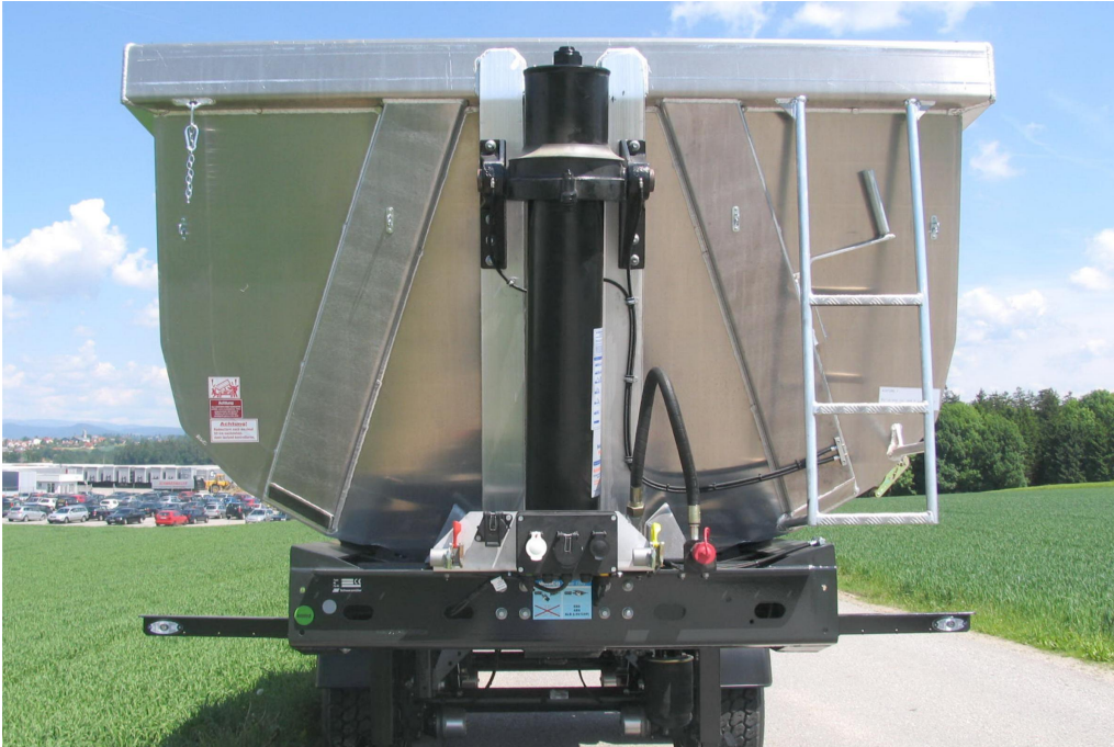
Ferde kivitelű mellfal, magas minőségű krómozott munkahengerrel
