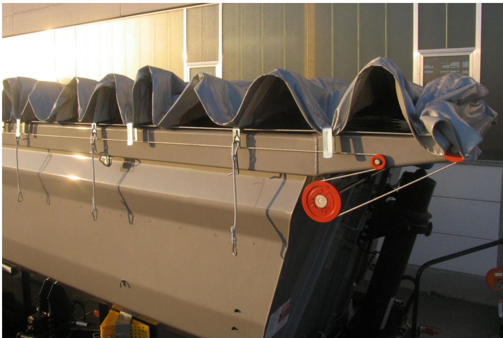
Rolós tetőszerkezet - manuális vagy elektromos távvezérléssel kezelhető
