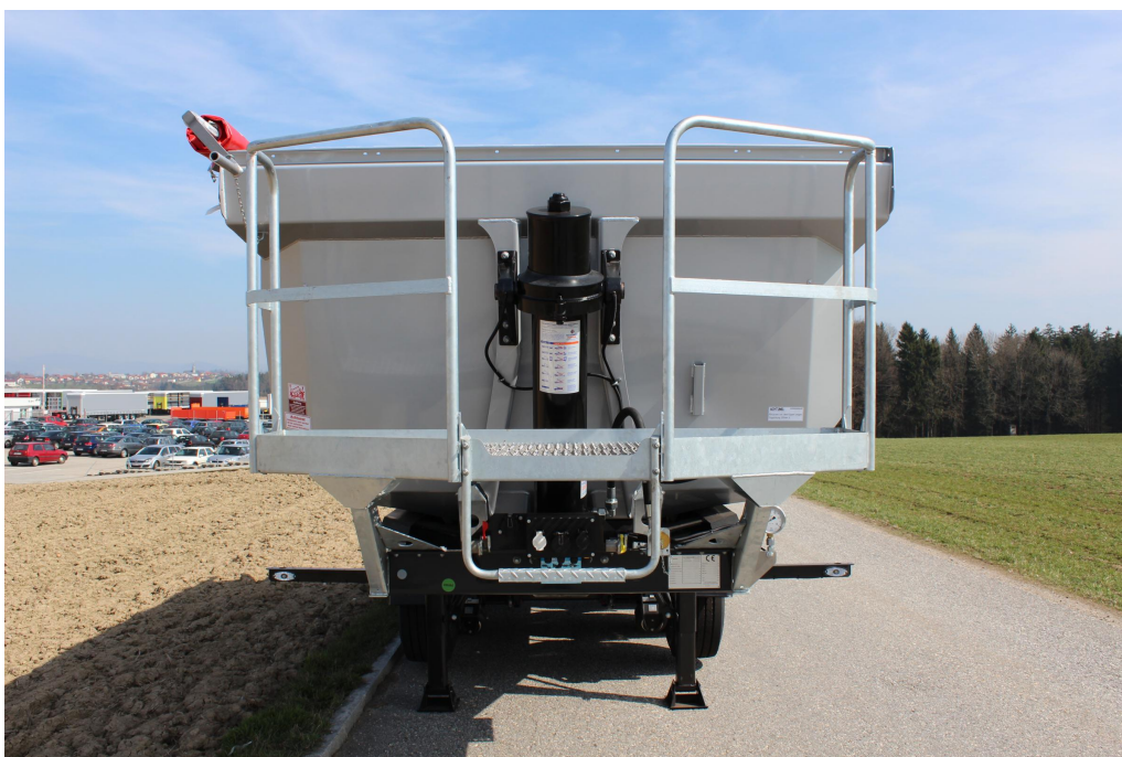
Rolós tetőszerkezet - manuális vagy elektromos távvezérléssel kezelhető
