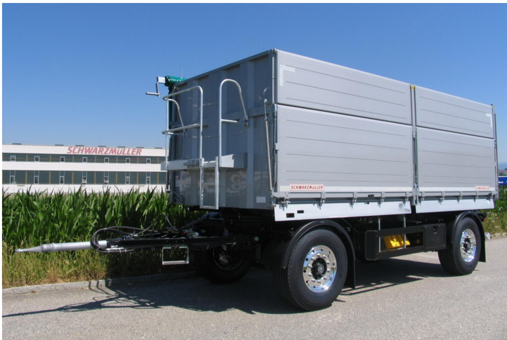
2-tengelyes, 3-oldalra billenő pótkocsi - gabona szállítására
