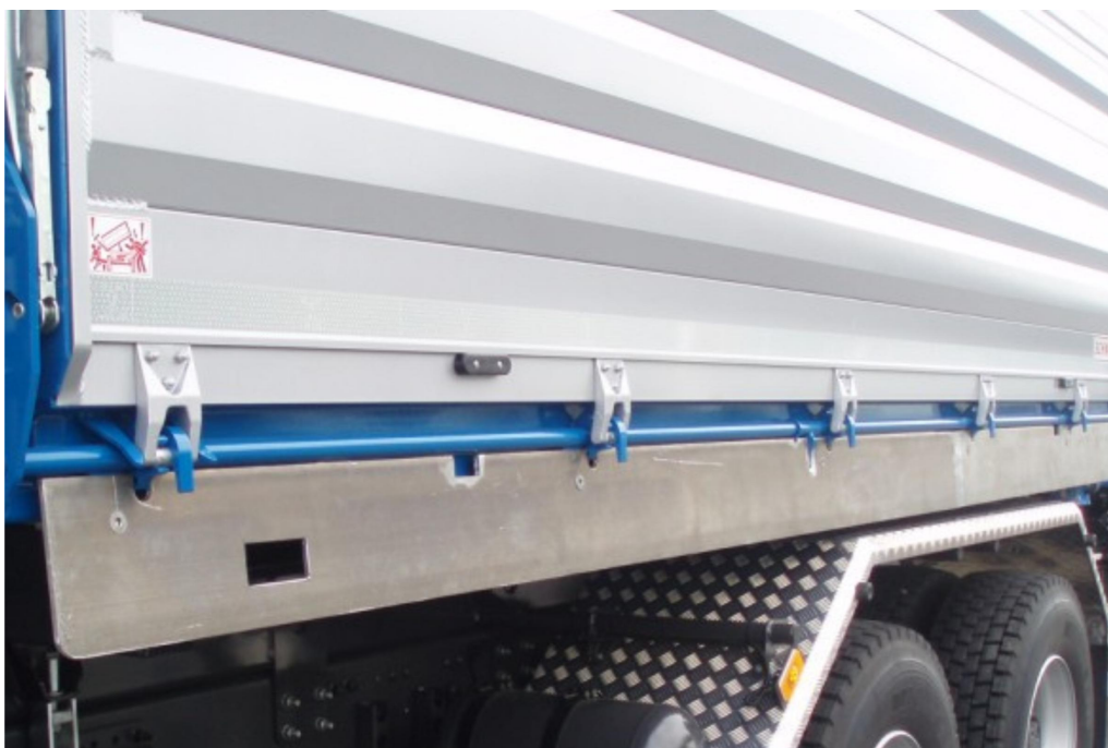
2-tengelyes, 3-oldalra billenő pótkocsi - gabona szállítására
