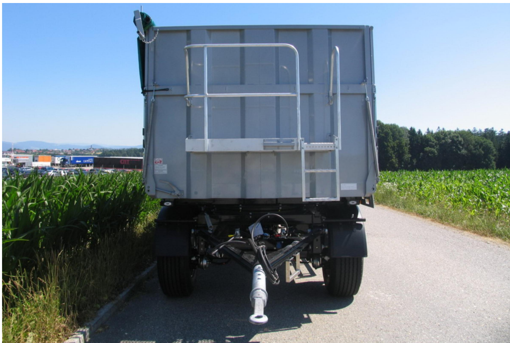
Előlnézet - rögzített acéllemez mellfal és szilentblokk perselyezésű vonóháromszög
