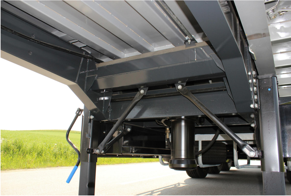
Stabil és csavarodásálló alvázkonstrukció, torzióscsövekkel kiegészítve, 3-oldalra billentéshez
