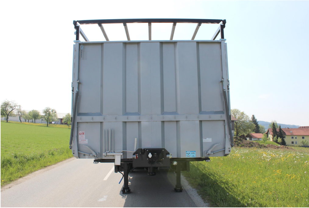
Rögzített acéllemez mellfal, 3 mm vastag
