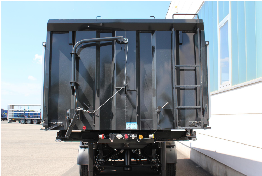
Stabil és csavarodásálló alvázkonstrukció, torzióscsővel kiegészítve, 3-oldalra billentéshez
