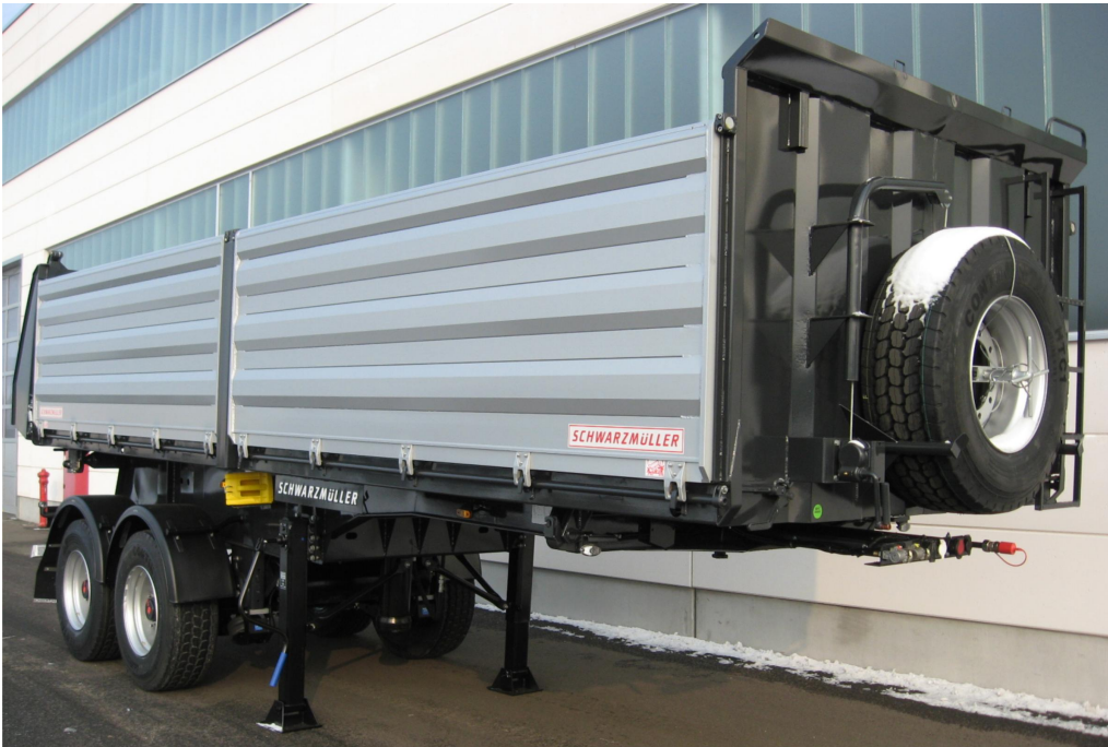
2-tengelyes, 3-oldalra billenő pótkocsi - építőipari kivitel
