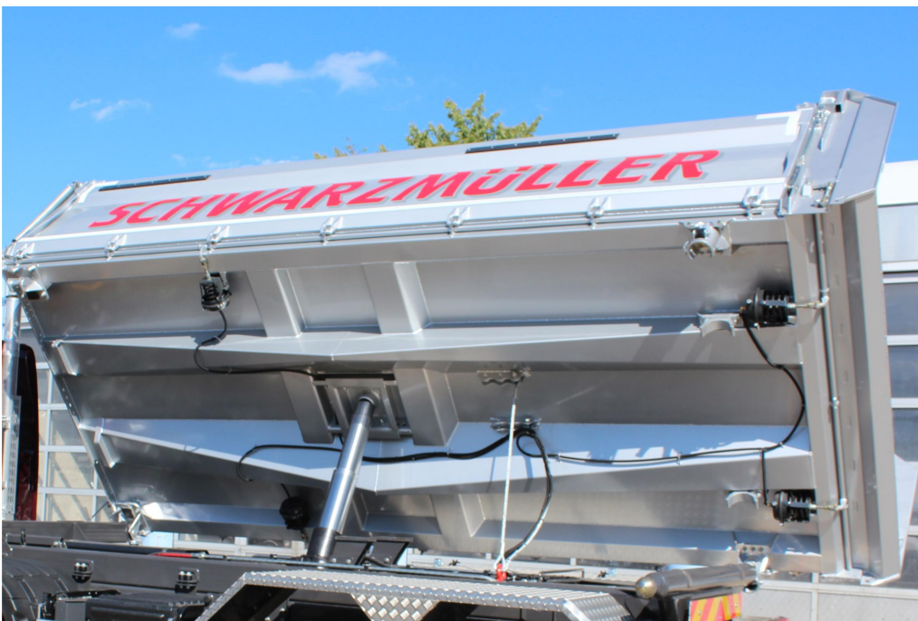
2-tengelyes, 3-oldalra billenő pótkocsi - építőipari kivitel
