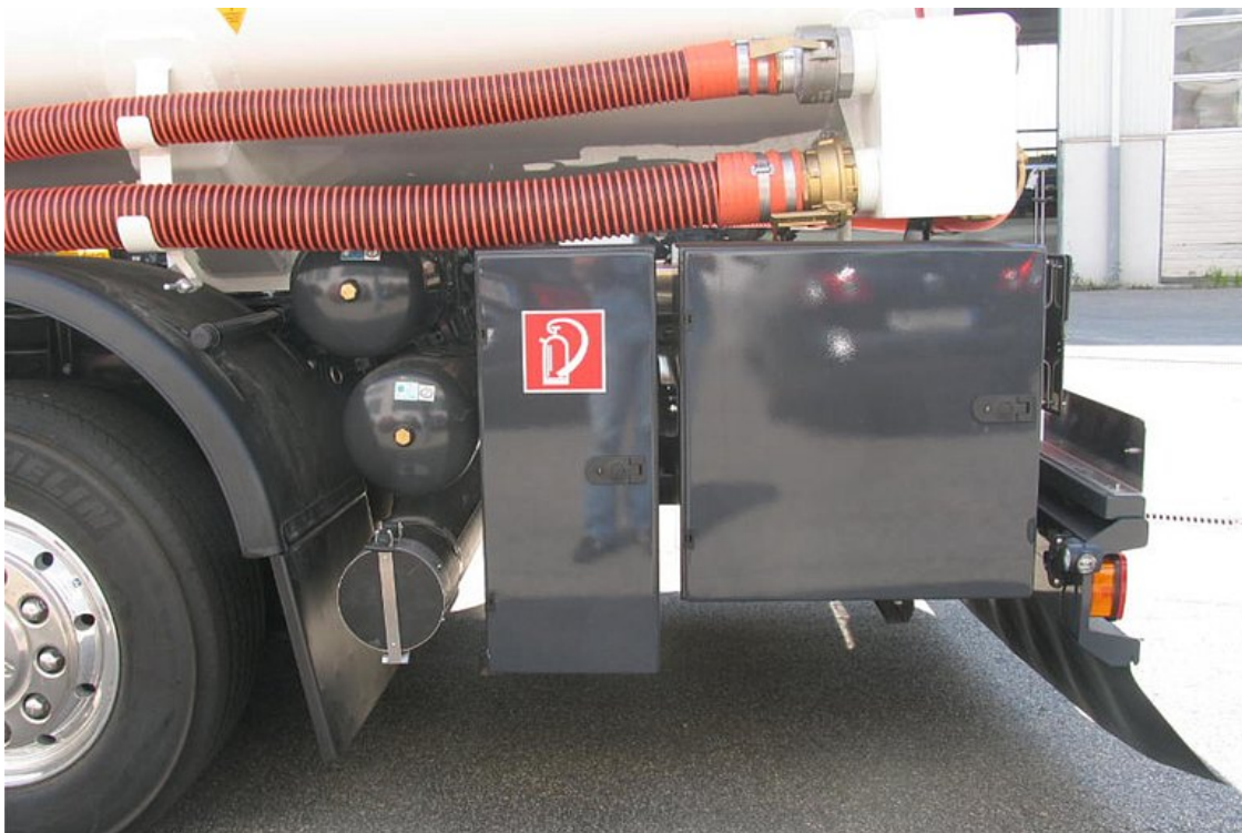
Alumínium tárolóláda a 12 kg-os tűzoltókészülék és a tartozékok számára
