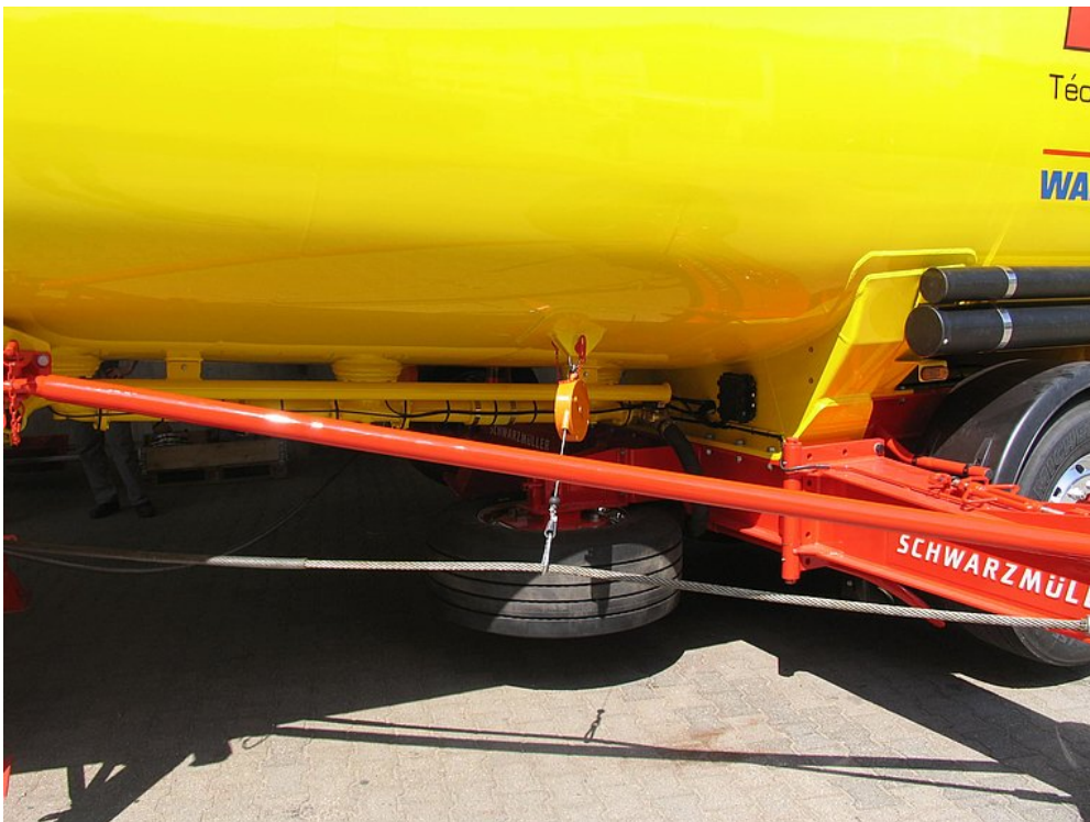
Knickschutzseile im Bereich der Auslegerabstützung zum Tank
