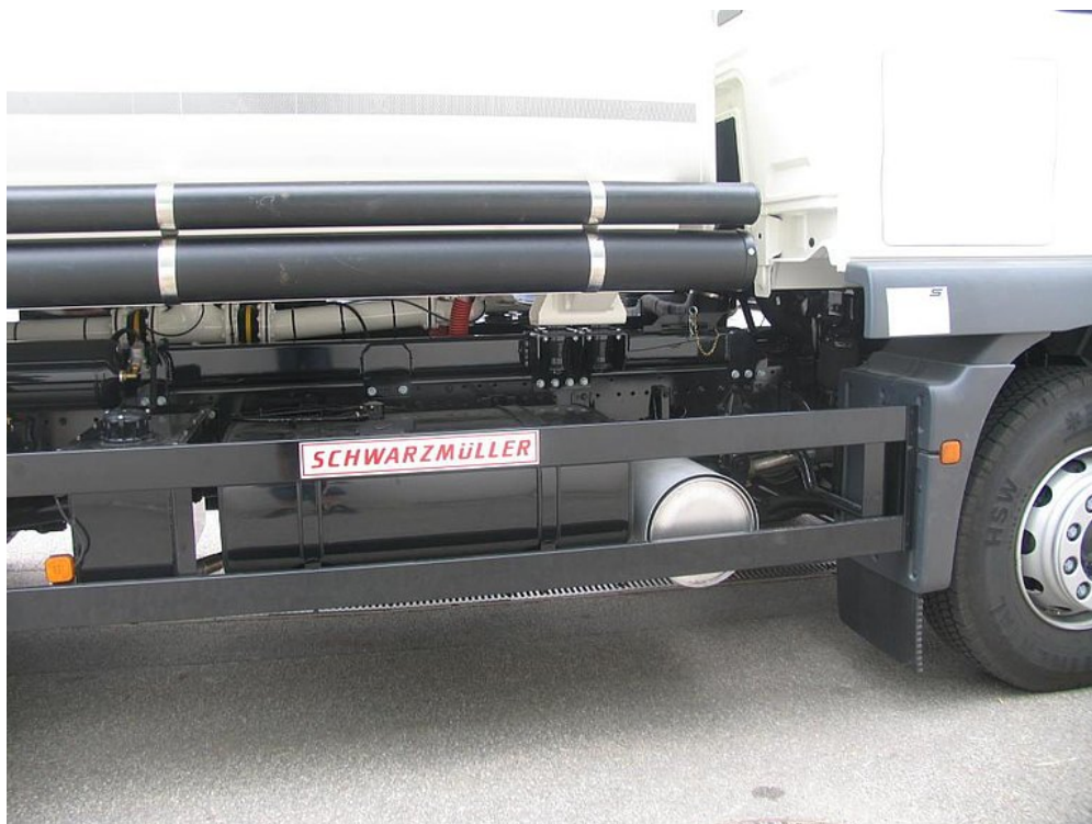
Oldalaláfutásgátló alumínium profilokból
