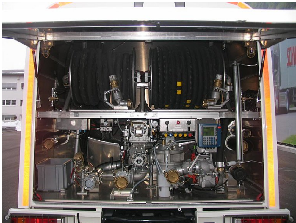
Hátsó armatúraszekrény a szivattyúnak és tömlődobnak, felfelé nyíló ajtóval
