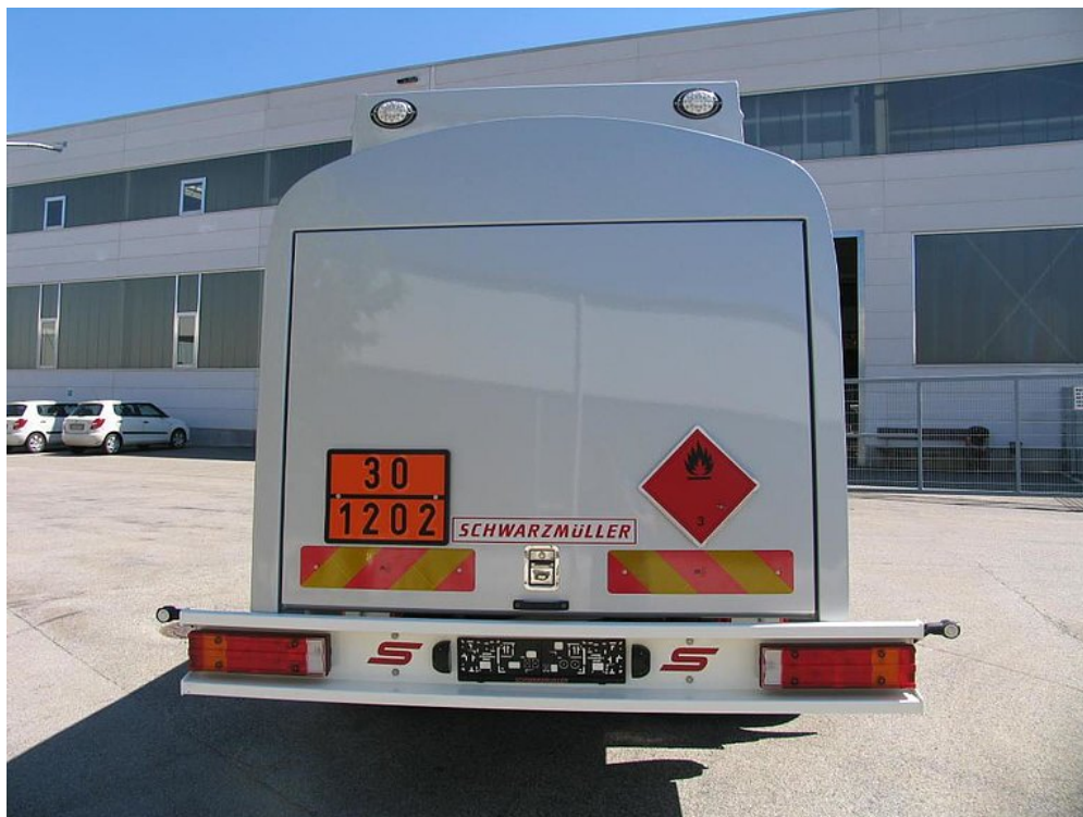
OPCIONÁLIS: 2 hátsó világítás felül a túlfolyóedénybe építve
