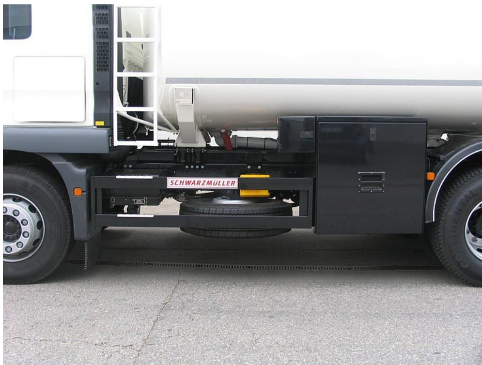
OPCIONÁLIS: pótkerék felszerelésének a lehetősége
