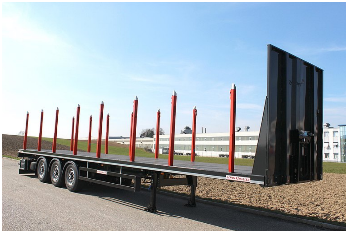
3-tengelyes, rönkszállító félpótkocsi - platós
