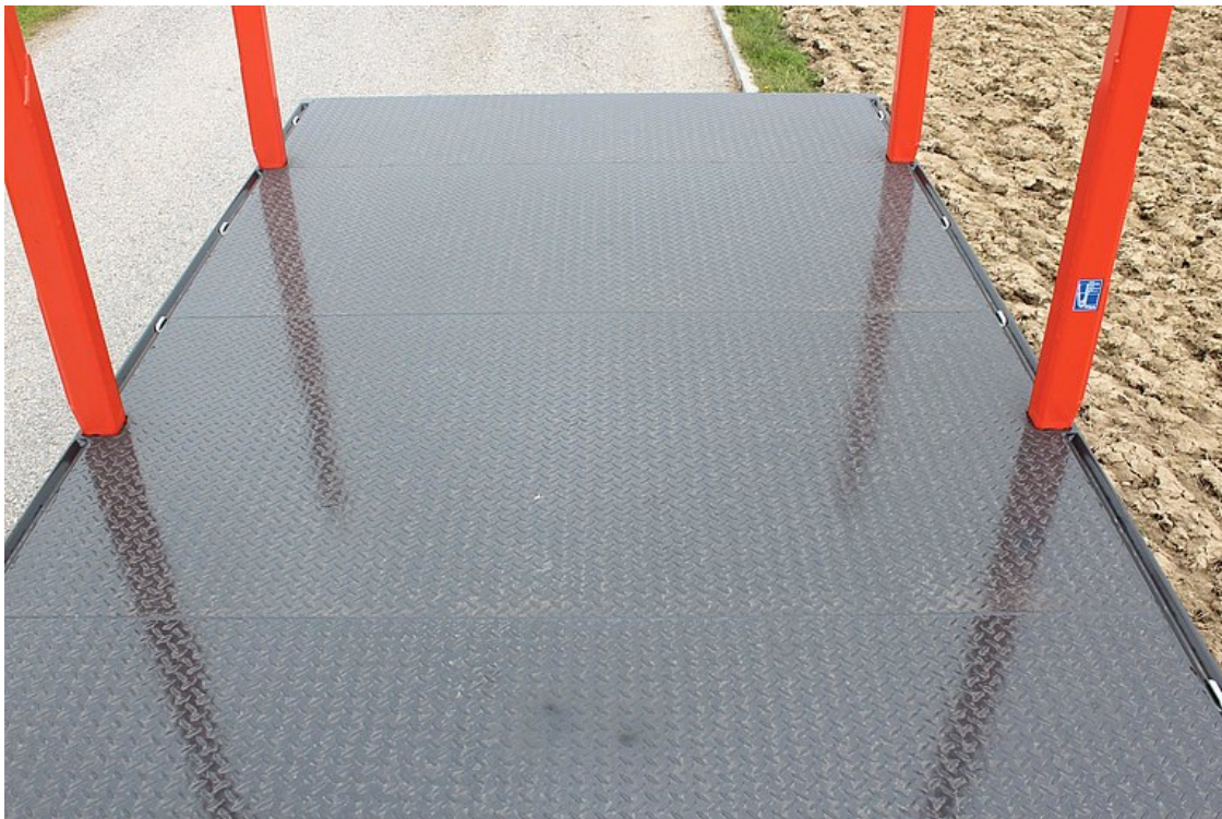
5/7 mm vastag bordázott acéllemez padló, ponthegeesztve
