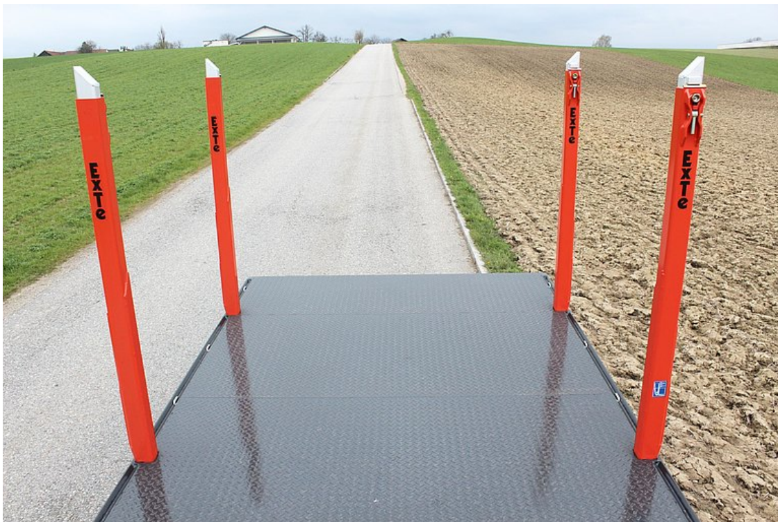
Exte-rakoncazsebek, erősített kereszttartóval, 2-részes csavarkötéssel rögzített Exte 144S rakoncákkal (terhelhetőség rakoncapáronként 7 t)
