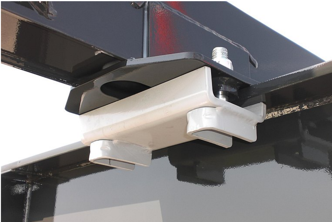
Rakoncabakok hegesztett szorítópofákkal rögzítve - áthelyezhető
