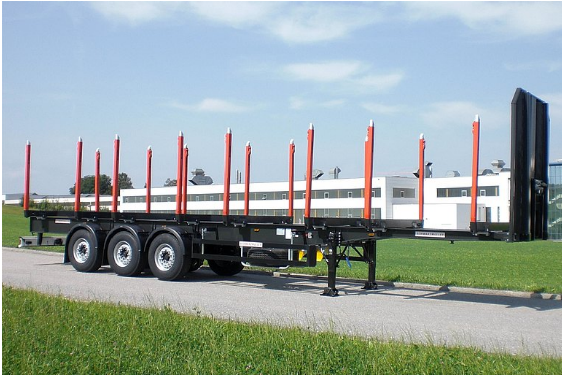
3-tengelyes, rönkszállító félpótkocsi - plató nélkül
