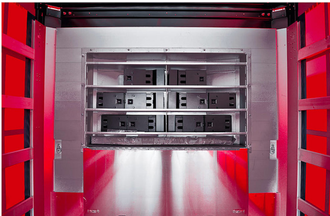
OPCIONÁLIS: Éktartó szekrény (papírszállító): A papírtekercsek szállításhoz használt rögzítőékeket ebben a mellfalba integrált szekrényben lehet tárolni. A szekrény a sofőr számára közvetlenül a raktérből hozzáférhető.
