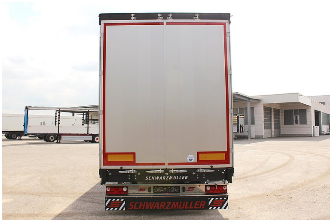
Hátul csavarkötéssel rögzített portál alumínium oszlopokkal, kétszárnyú teliajtóval alumínium profilokból
