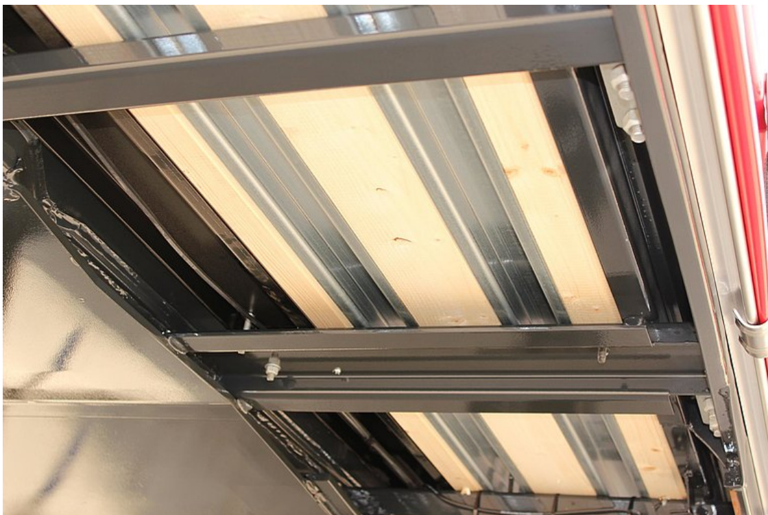
Dupla padló, mely egyrészt alumínium omegasínekkel erősített fenyőfa padló, valamint egy érdesített koptató lemez (7 t targoncatengely-terhelés)
