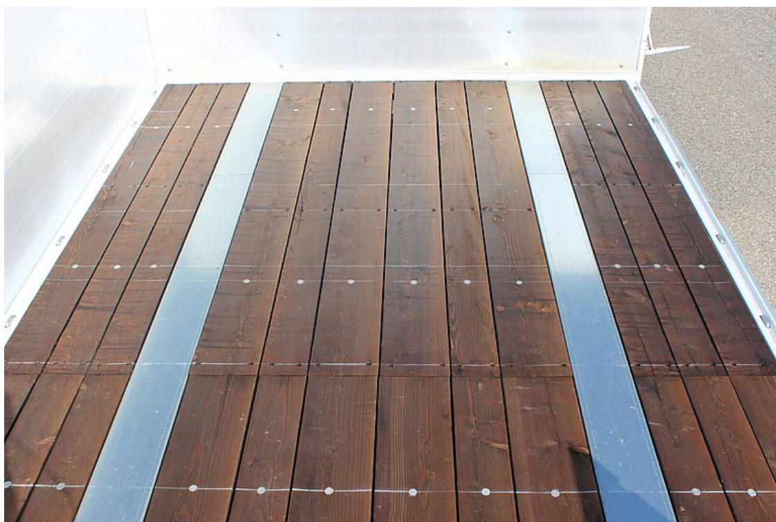
OPCIONÁLIS: időjárásálló, 40 mm vastag vörösfenyő- vagy keményfa padló, koptató nélkül
